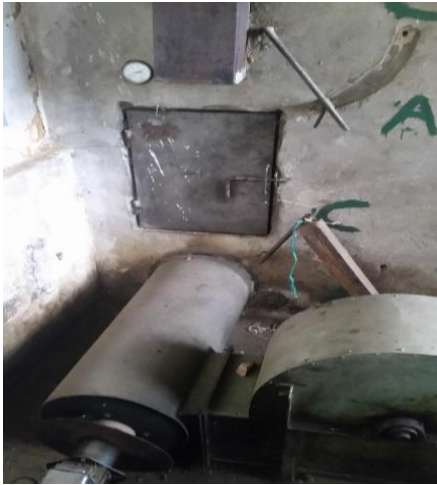
Boca del serpentín y Cámara principal de secado
