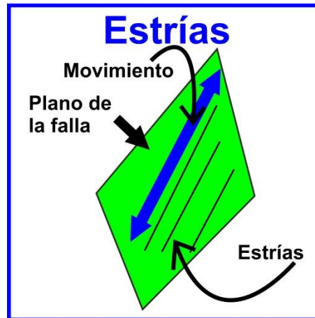
Figura 10. Imagen esquemática de la representación de estrías de falla sobre un plano de falla y su movimiento relativo.
