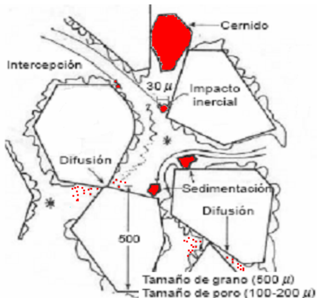
Figura 9.1 Diferentes mecanismos que pueden realizar transporte
