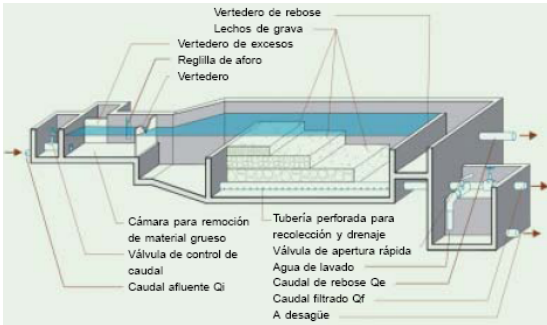
Figura 11.3 Esquema de un Filtro Grueso Dinámico (FGDi)
