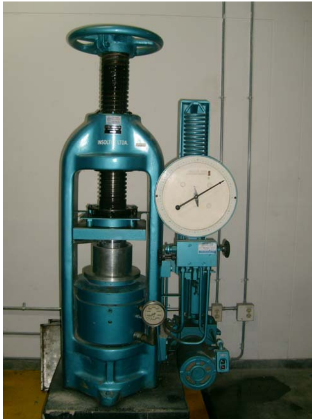
Figura 8. Compresión de la muestra en la máquina universal
