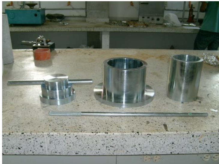
Figura 6. Equipo utilizado para el ensayo de 10% de finos
