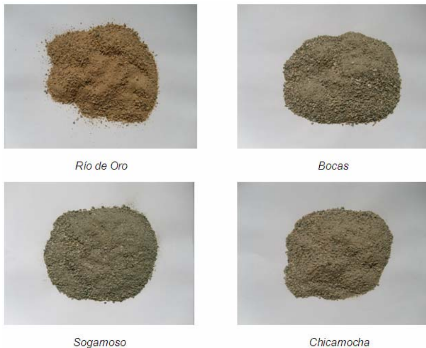
Figura 10. Fragmentos resultados del ensayo de 10% de finos
