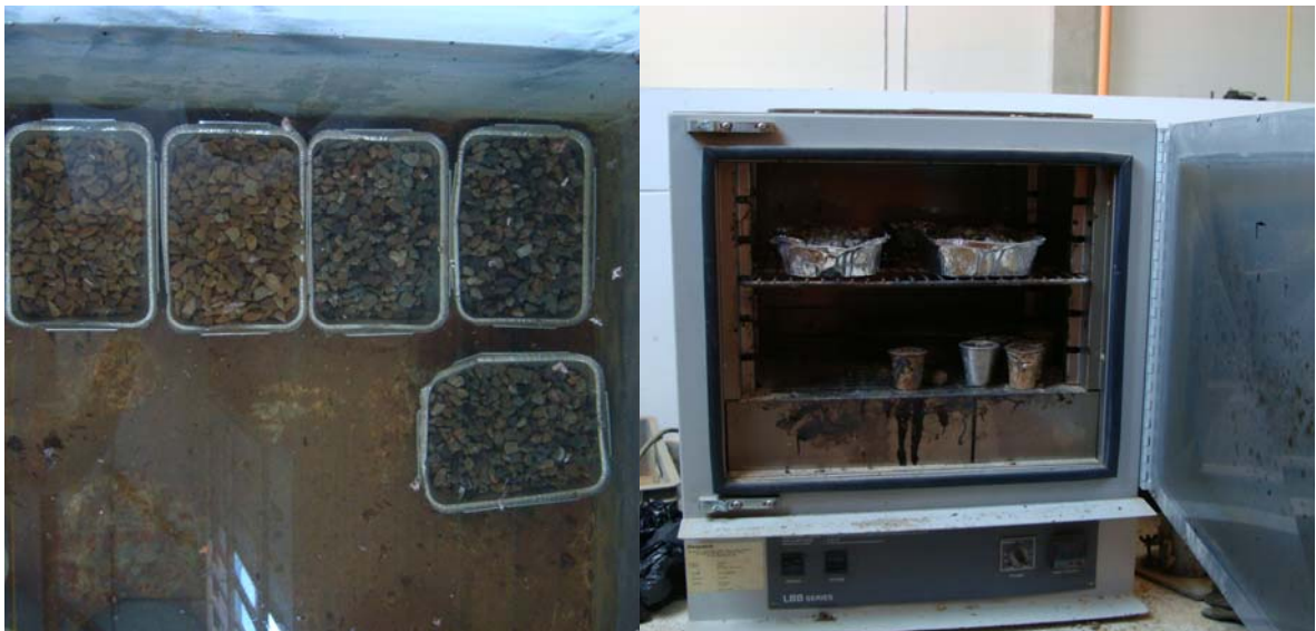
Figura 9. Agregado sumergido en agua y secado luego de aplicar la carga
