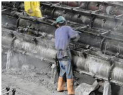
Figura 9. Llenado de las formaletas con la materia prima
