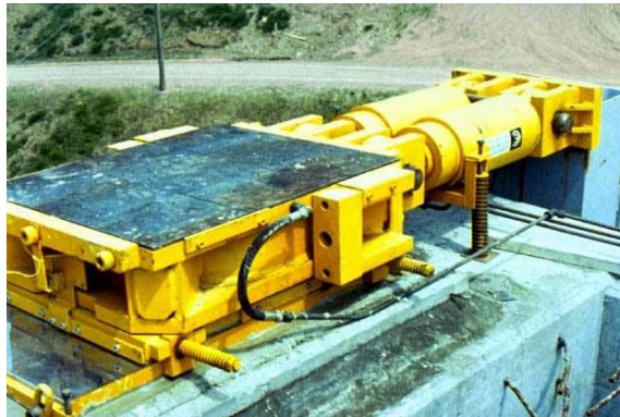
Figura 2.13 Dispositivo de lanzamiento mediante gatos hidráulicos.
