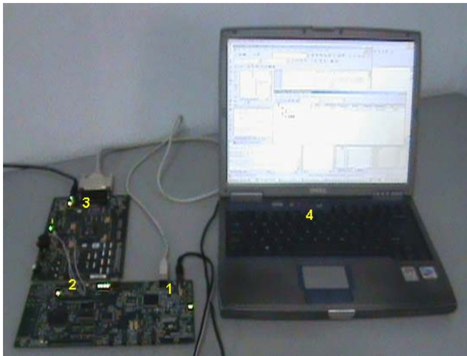
Figura 6. Hardware total implementado. 1) Conexión USB al PC y Fuente de alimentación C6713. 2) Conexión a través del McBSP para la transmisión y recepción. 3) Conexión puerto paralelo al PC y Fuente de alimentación C6711. 4) PC con CCS.
