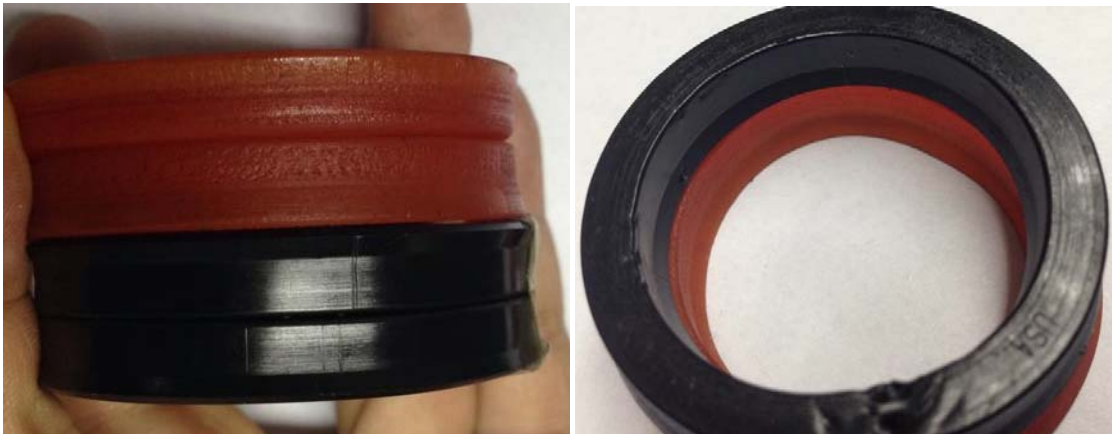
Figura 101. Comparación de los daños en los sellos a) A 1000 Psi (Pruebas 1 y 4)
