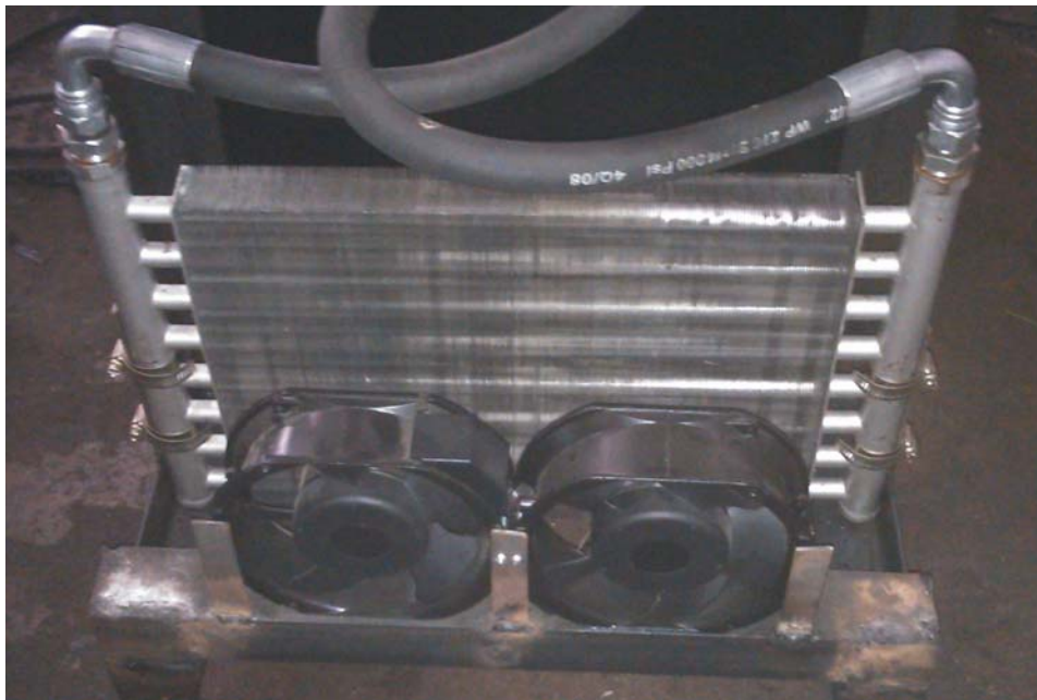
Figura 52. Disipador de calor
