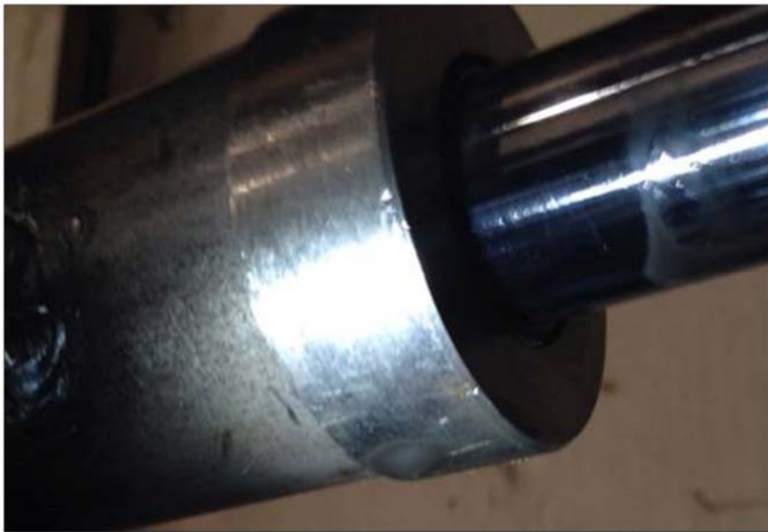
Figura 100. Fuga de aceite en la tapa con sellos importados
