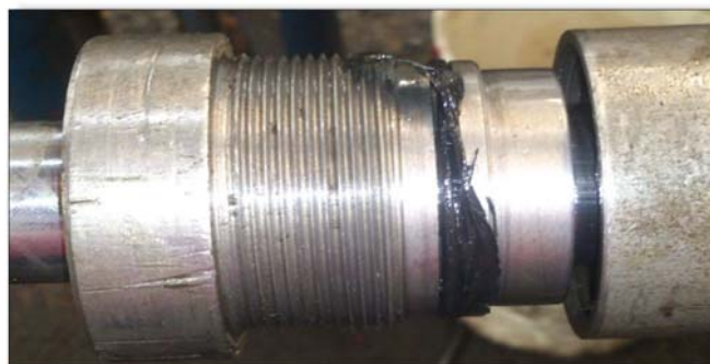
Figura 97. Deformación del Oring de la tapa a 2500 psi.
