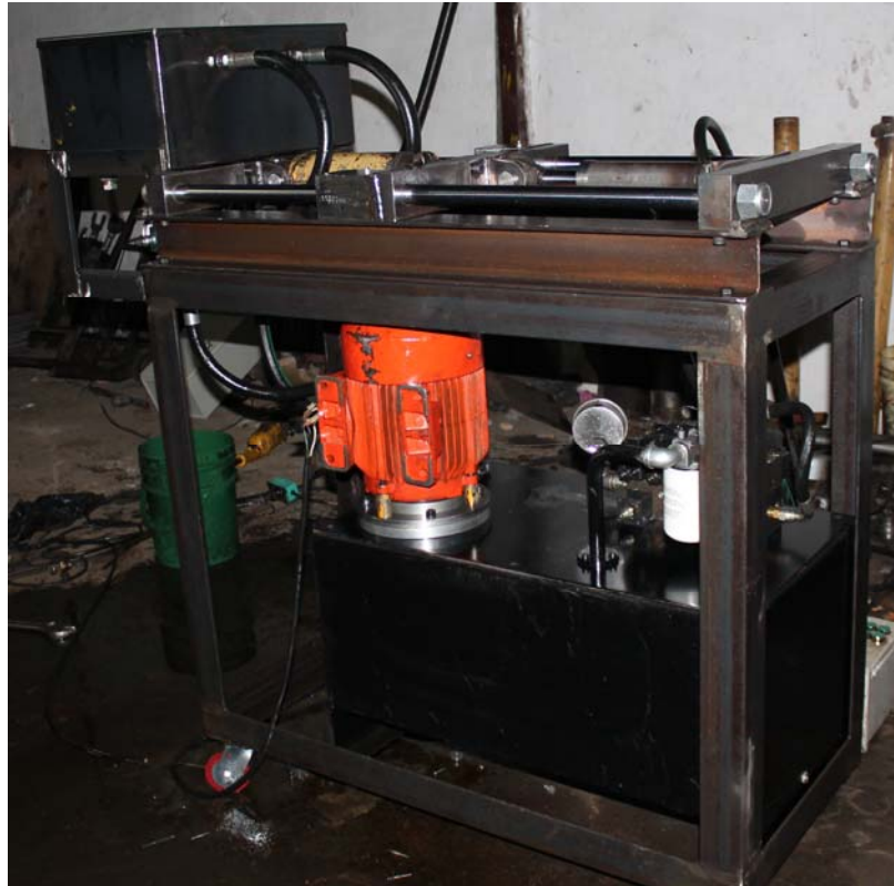
Figura 80. Tanque del sistema hidráulico colocado en la estructura
