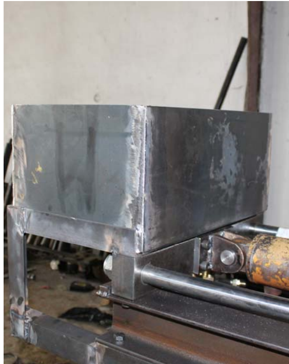
Figura 79. Tanque superior del banco de pruebas
