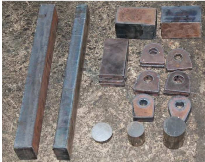
Figura 69. Cortes en plasma de las piezas de la estructura
