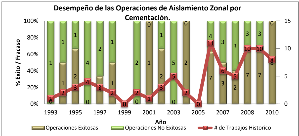
Grafica 25. Desempeño histórico de las operaciones de aislamiento zonal por squeeze con los datos de la aplicación de la nueva metodología en 2010.
