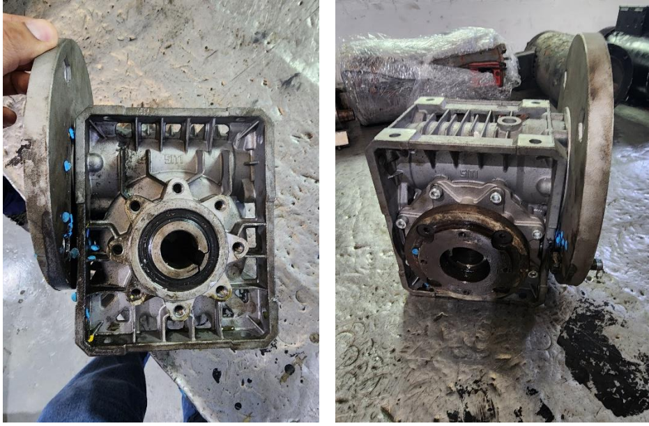
Figura 5. Detalles de fugas de aceite y reductores fallados.
