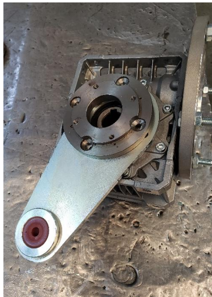
Figura 10. Evidencia de Motores instalados en la forma de montaje correcta con Brazo de torsión.
