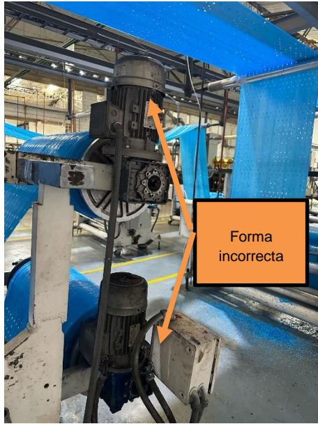
Figura 9. Evidencia de Motorreductores instalados en la forma de montaje incorrecta y correcta.
