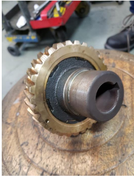
Figura 6. Detalles corona de bronce motorreductores desgastada.
