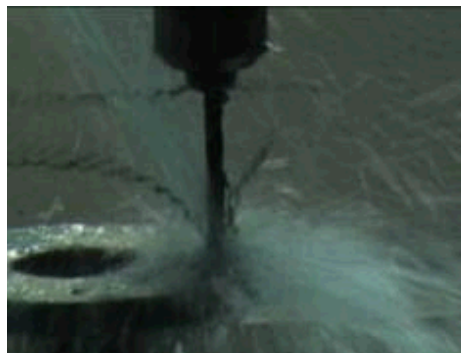
Figura 29. Inefectividad de aplicación a chorro del fluido de corte en el taladrado.
