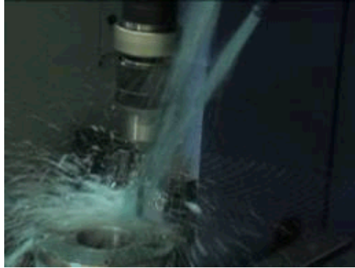
Figura 28. Aplicación fluido de corte a chorro.
