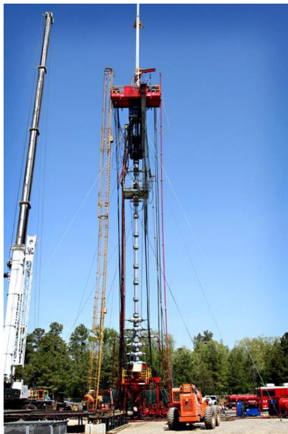
Imagen 4 Fotografía Equipo tipo Snubbing. (Disponible en línea: https://www.inparkdrilling.com/snubbing-services/ )
