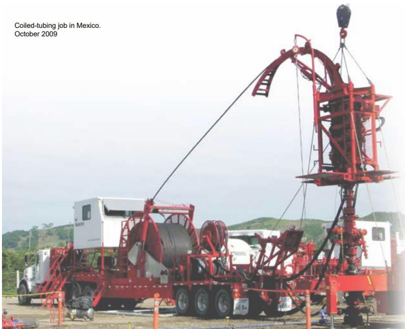
Imagen 3 Fotografía Equipo tipo Coiled Tubing. (Disponible en línea: https://www.weatherford.com/documents/brochure/products-and-services/intervention-and-abandonment/coiled-tubing-services/ )
