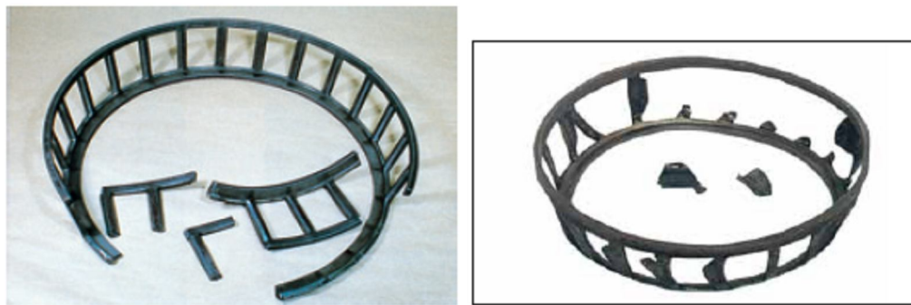
Figura 45. Daño en canastilla por vibración excesiva.
