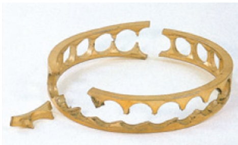
Figura 47. Daño en la canastilla debido a lubricación inadecuada.
