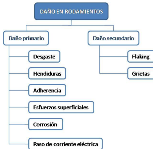
Figura 27. Tipos de daño en rodamientos.
