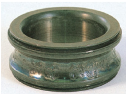
Figura 42. Descascarado causado por excesiva carga axial.
