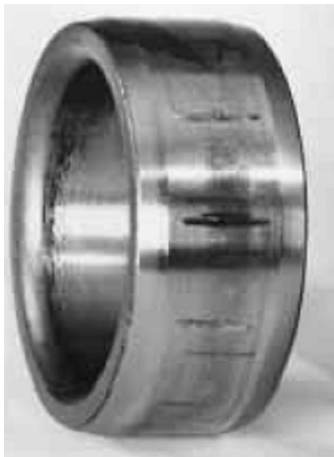
Figura 29. Anillo interior expuesto a desgaste por vibración.
