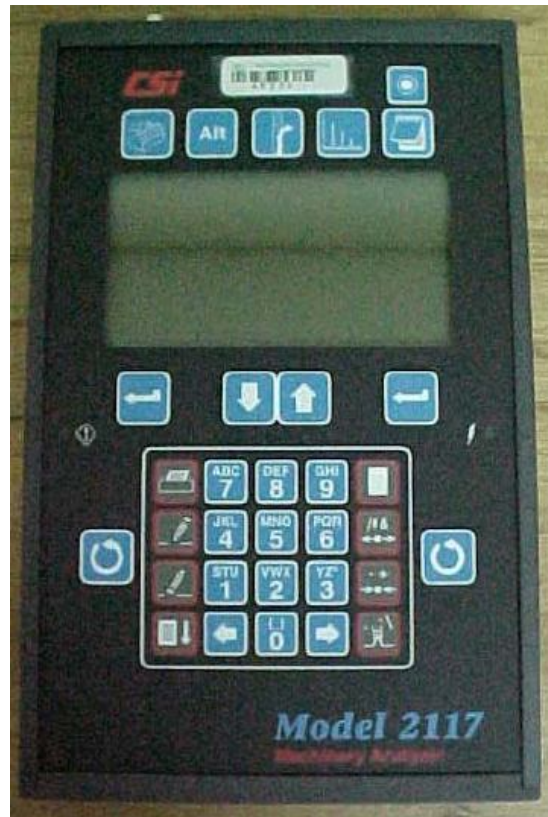
Figura 85. Analizador de vibraciones CSI.
