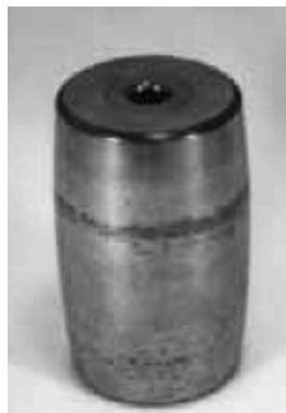
Figura 37. Fatiga superficial en forma de bandas laterales.
