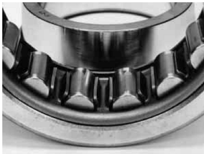
Figura 35. Rastros de Adherencia en la pista exterior espaciado a la distancia de los elementos rodantes.
