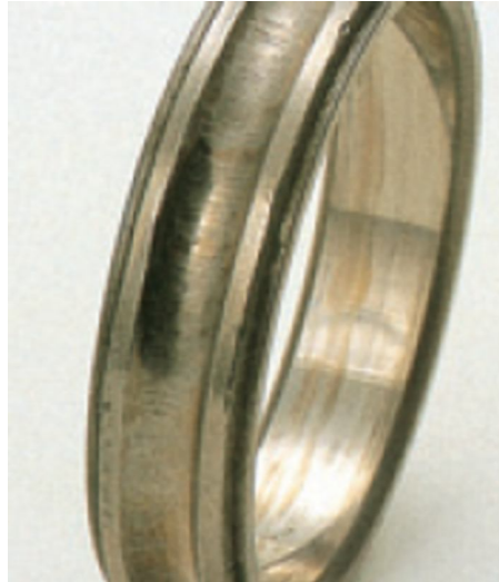
Figura 39. Anillo interno con señales de corrosión por movimiento relativo.
