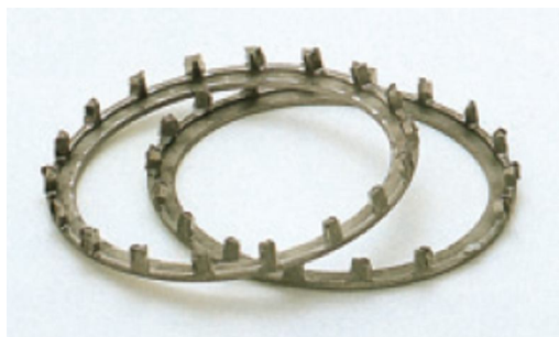
Figura 46. Canastilla rota debido a fatiga.
