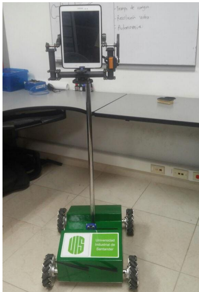
Figura 31. Robot de telepresencia versión 1.0 (RTPV1.0).
