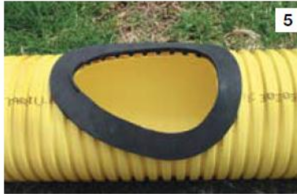
Figura 23. Colocación del caucho
