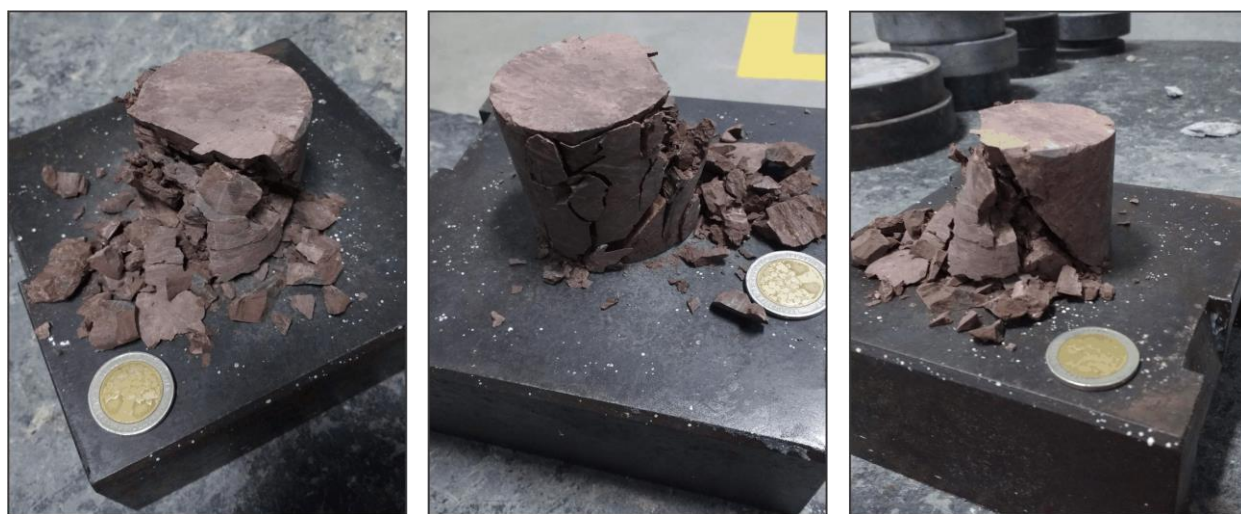
Figura 23. Fotografía de fallamiento de la muestra ME-1.
