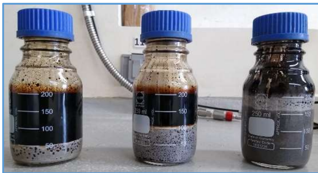
Figura 32. Prueba de compatibilidad Thixsal – crudo PA 06 (24 horas).
