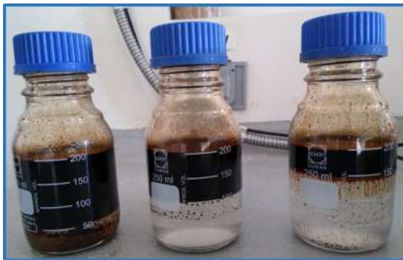
Figura 38. Prueba de compatibilidad Salmuera – crudo PA 41 (24 horas).
