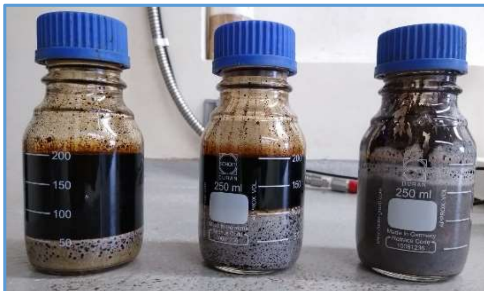
Figura 29. Prueba de compatibilidad Thixsal – crudo PA 06 (4 horas).
