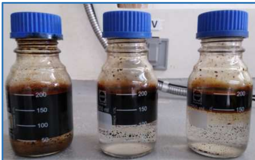
Figura 37. Prueba de compatibilidad Salmuera – crudo PA 41 (12 horas).
