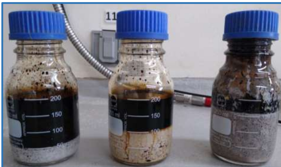
Figura 42. Prueba de compatibilidad Thixsal/Ultra – Crudo PA 41 (12 horas).
