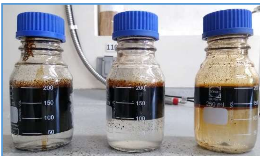
Figura 22. Prueba de compatibilidad NaCl – crudo PA 06 (4 horas).
