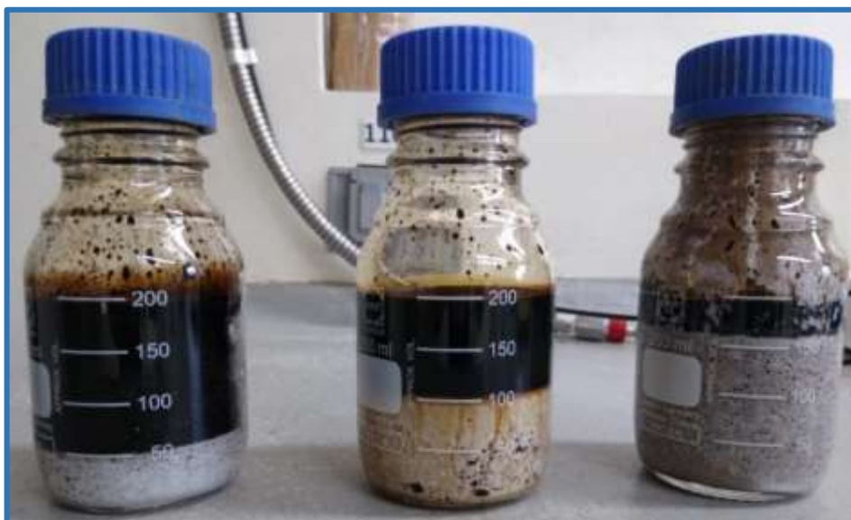
Figura 41. Prueba de compatibilidad Thixsal/Ultra – Crudo PA 41 (6 horas).
