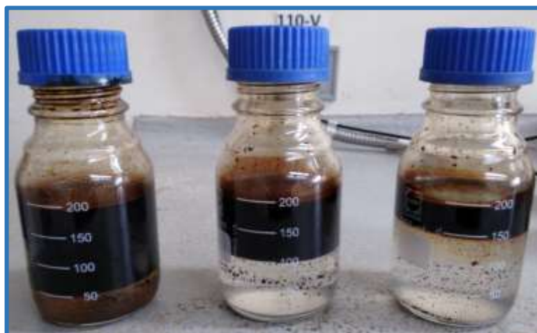
Figura 35. Prueba de compatibilidad Salmuera – crudo PA 41 (4 horas).
