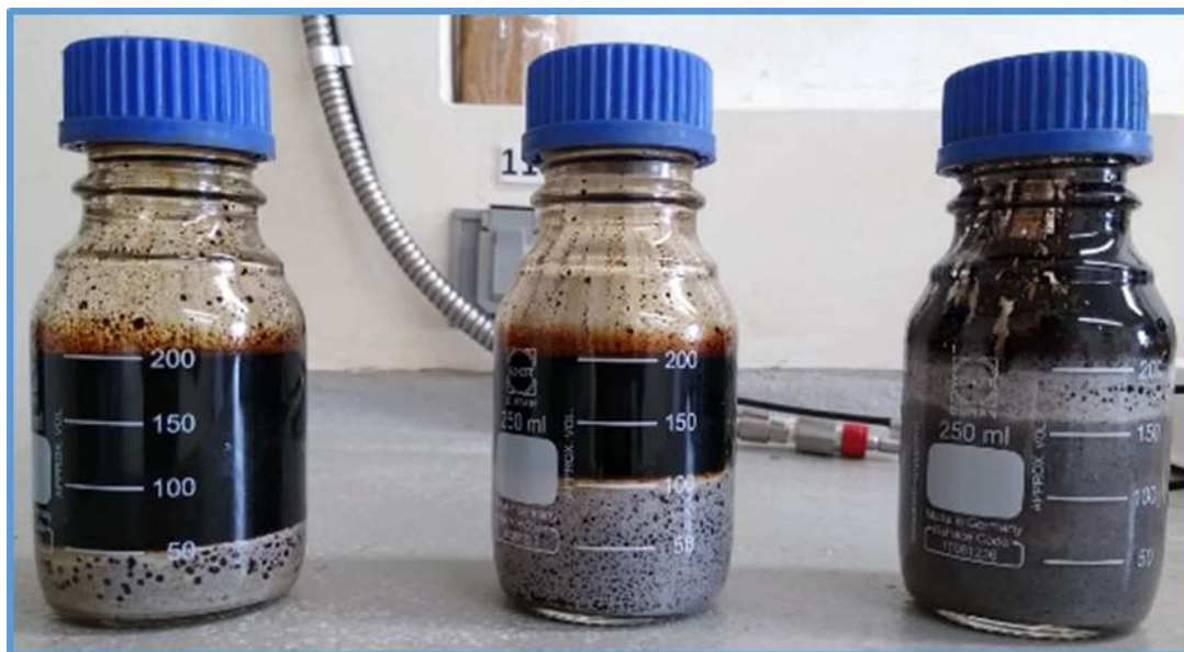
Figura 31. Prueba de compatibilidad Thixsal – crudo PA 06 (12 horas).
