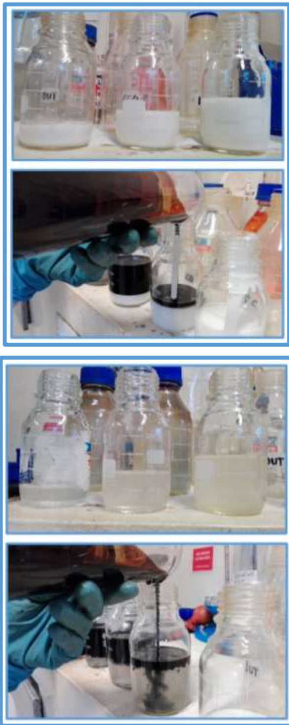
Figura 20. Preparación de la mezcla para evaluar compatibilidad con el fluido PA-06.
