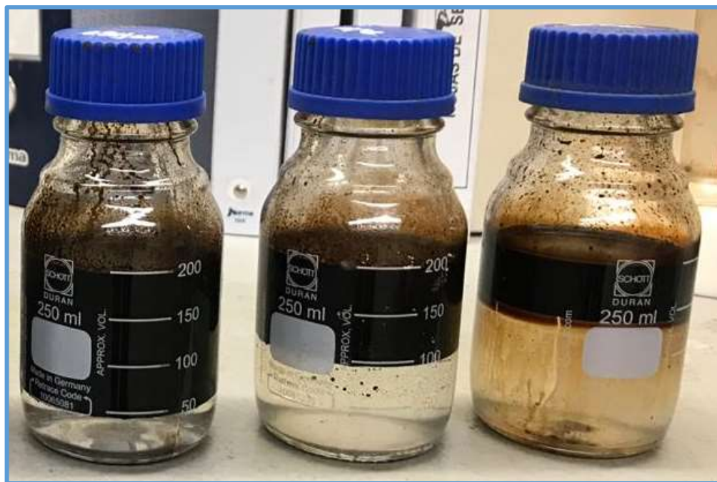
Figura 23. Prueba de compatibilidad NaCl – crudo PA 06 (6 horas).
