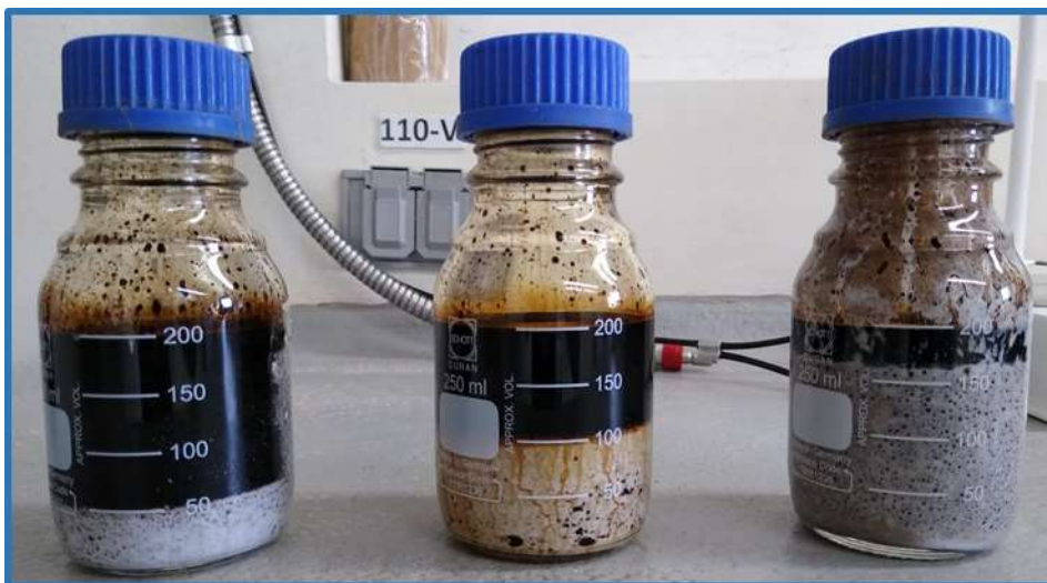
Figura 40. Prueba de compatibilidad Thixsal/Ultra – Crudo PA 41 (4 horas).
