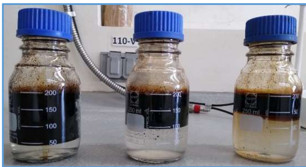
Figura 24. Prueba de compatibilidad NaCl – crudo PA 06 (12 horas).
