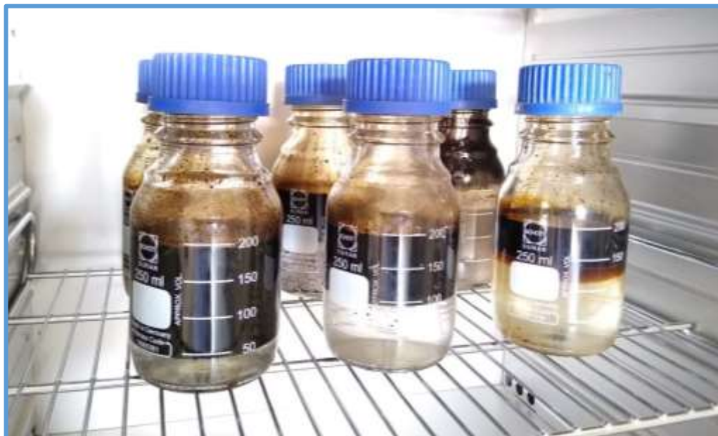
Figura 25. Prueba de compatibilidad NaCl – crudo PA 06 (12 horas).
