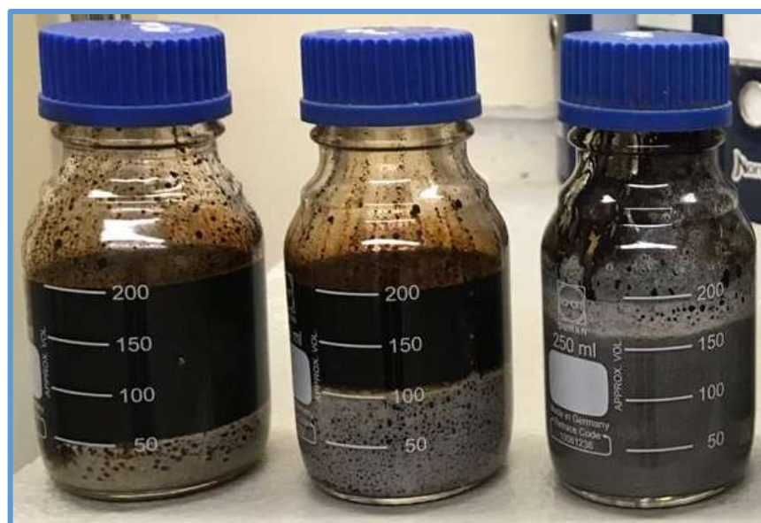
Figura 30. Prueba de compatibilidad Thixsal – crudo PA 06 (6 horas).
