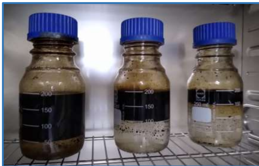
Figura 36. Prueba de compatibilidad Salmuera – crudo PA 41 (6 horas).
