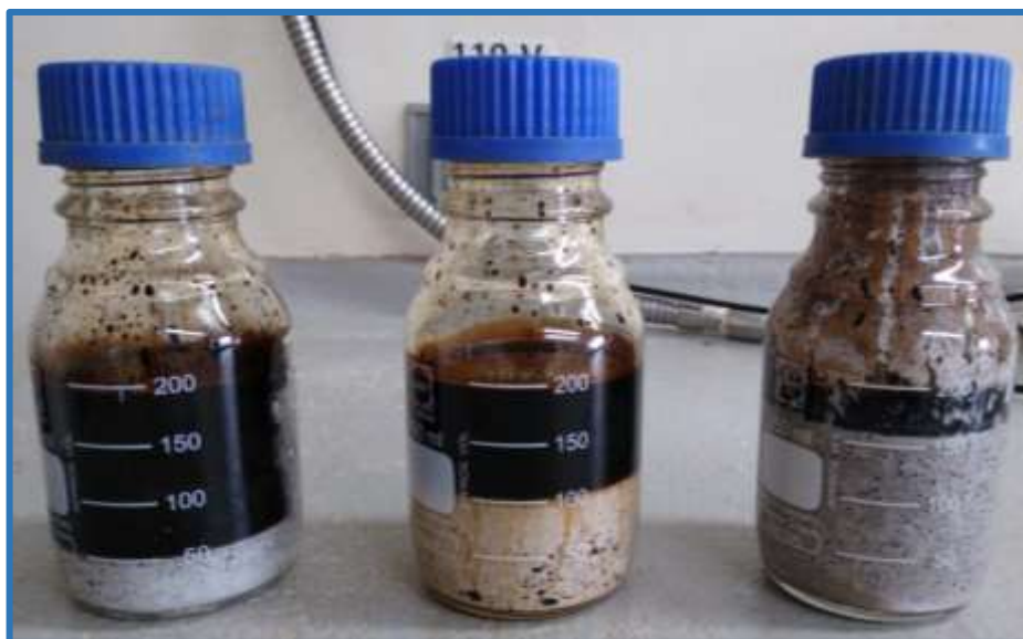
Figura 43. Prueba de compatibilidad Thixsal/Ultra – Crudo PA 41 (24 horas).
