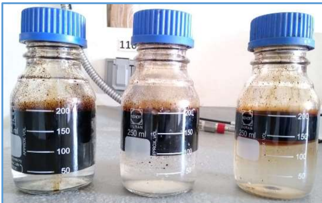
Figura 26. Prueba de compatibilidad NaCl – crudo PA 06 (24 horas).
