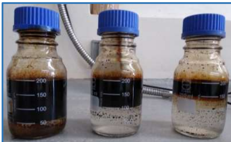
Figura 34. Prueba de compatibilidad Salmuera – Crudo PA 41 (2 horas).
