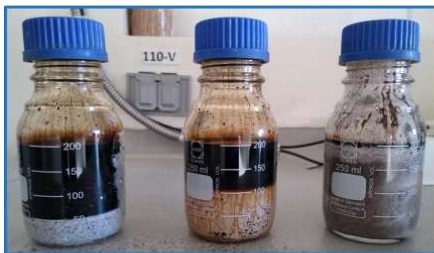
Figura 39. Prueba de compatibilidad Thixsal/Ultra – Crudo PA 41 (2 horas).
