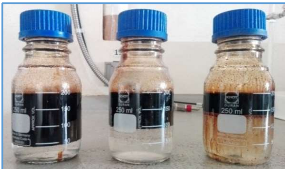
Figura 21. Prueba de compatibilidad NaCl – crudo PA 06 (2 horas).
