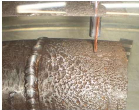
Figura 13. Sistema de inmersión para la sección de tubo soldado empleando palpador focalizado.
