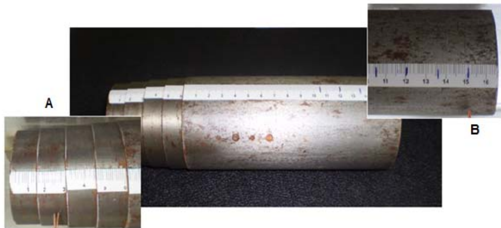
Figura 10. Tubo patrón. A) Cambios de espesor externos. B) Cambios de espesor en la pared interna.
