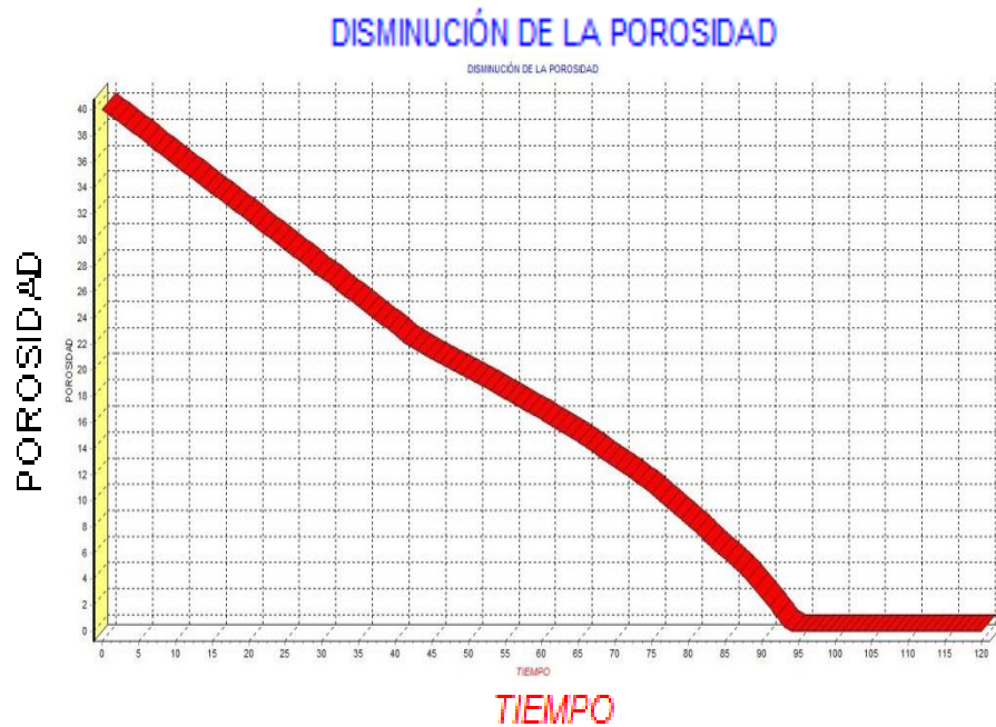
Figura 12. Colmatación del humedal
