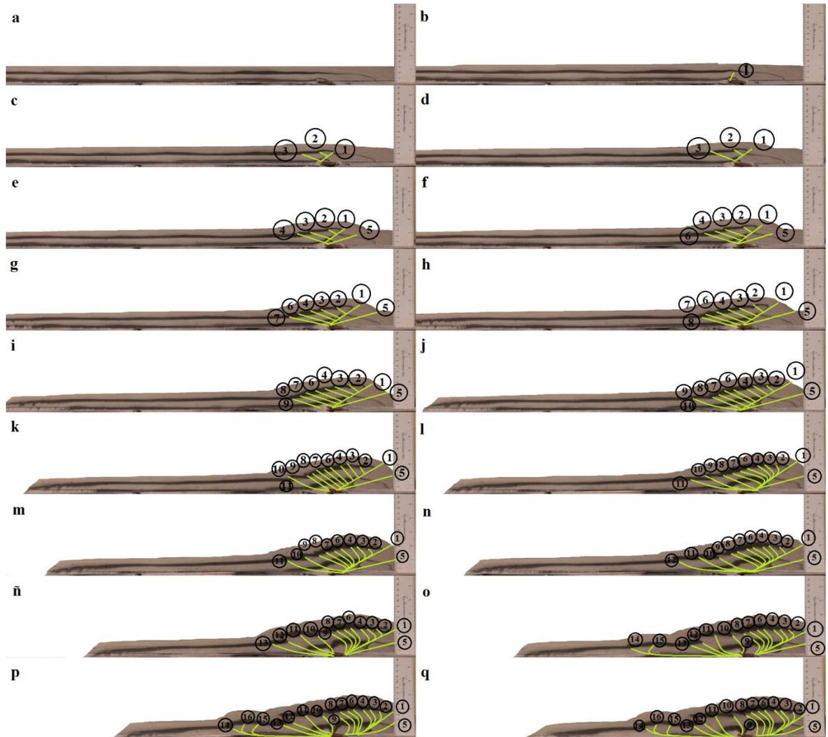
**Figura 43. Método gráfico para el cálculo del ángulo crítico ( $\delta$  y  $\delta^*$ ).**
