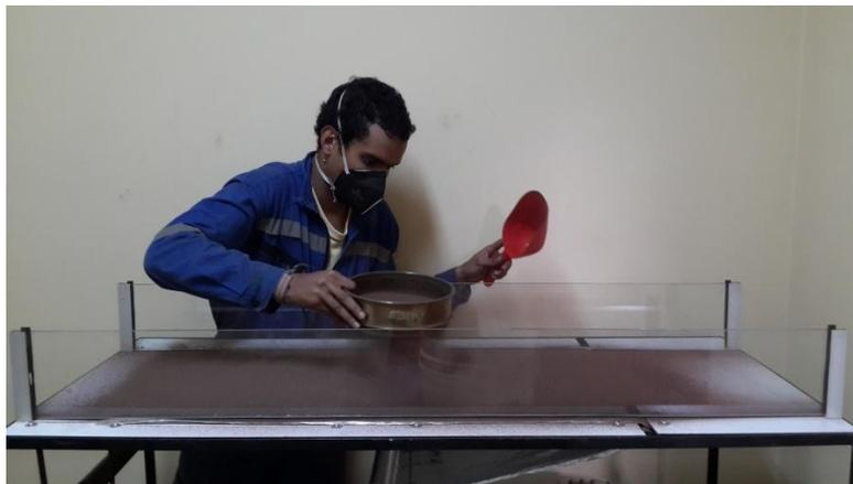
**Figura 18. Se observa la técnica empleada para nivelar a 1 cm (con ayuda de la llana) la primera capa de arena tipo I.**
