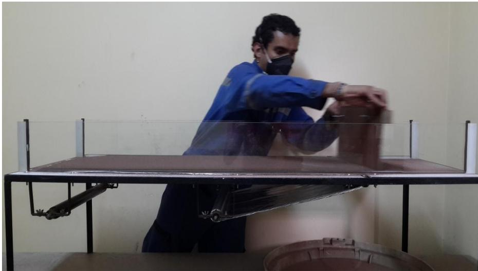
**Figura 19. Condiciones iniciales para la serie experimental de control, con arena tipo I, se observan los 3 niveles de arena, perfectamente nivelados.**
