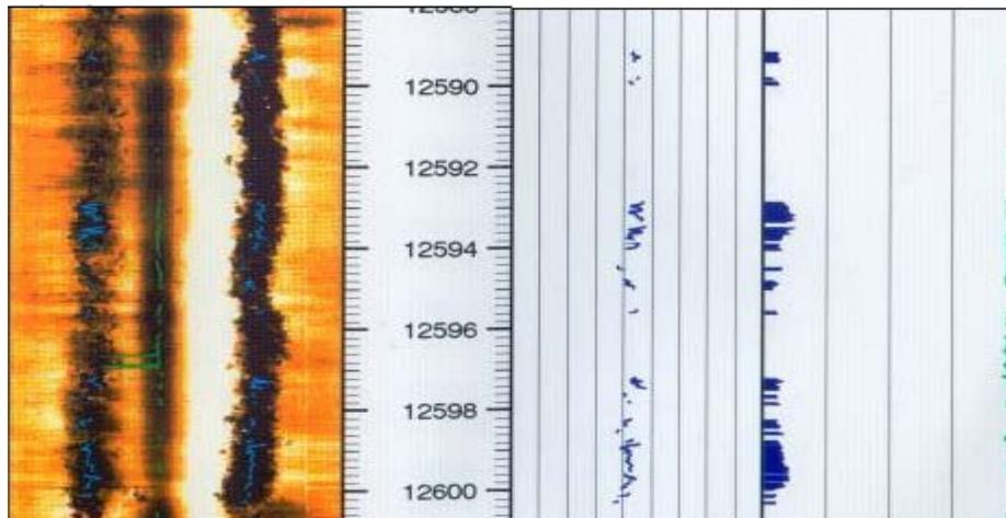
**Figura 29. Imagen de la Formación Mirador, en la cual se observa un Breakout
