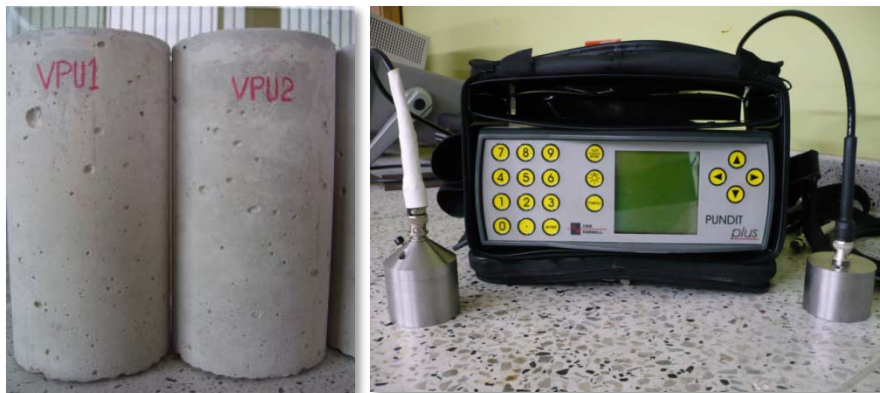
Figura 10. Probetas y equipo de ultrasonido
