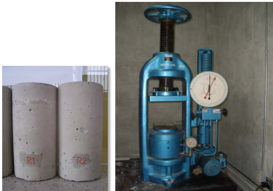
Figura 9. Probetas y máquina de ensayos AMSLER
