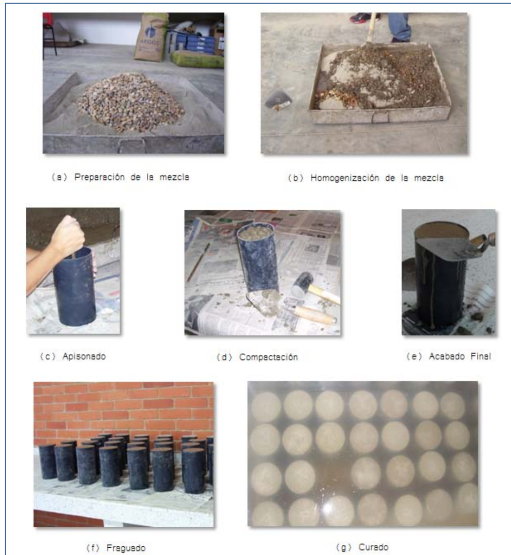
Figura 4. Elaboración de las probetas
