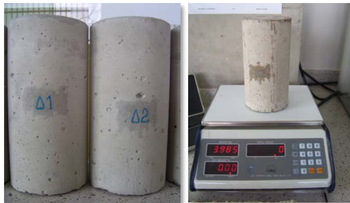
Figura 7. Registro masa de las probetas
