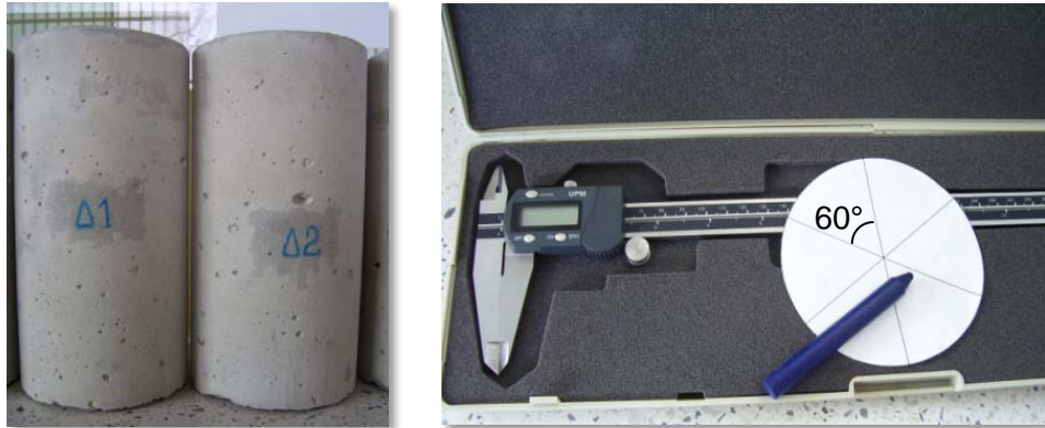
Figura 6. Registro dimensiones de las probetas
