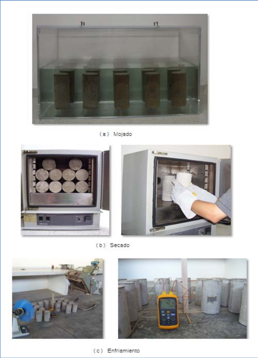
Figura 5. Esquema representativo de un ciclo de ataque acelerado
