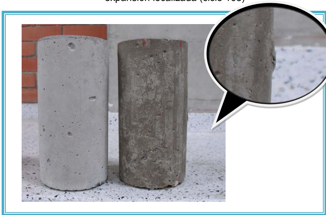
Figura 14. Fotografía comparativa de muestras con y sin ataque. Presencia de expansión localizada (ciclo 105)
