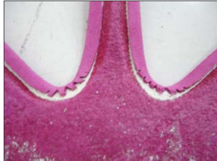
Foto 9. Quiebres a 45° para facilitar el doblar de las piezas
