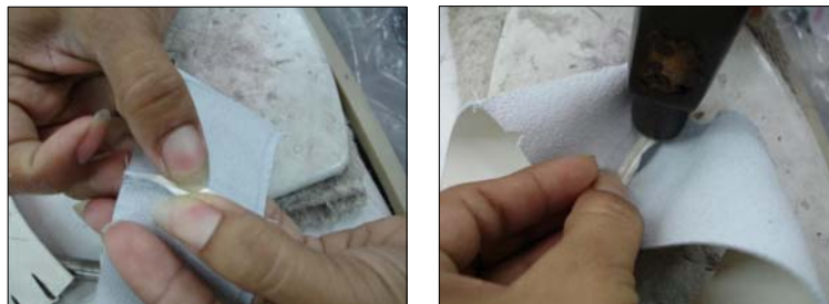
Se abre costura para asentar con martillo para que quede abierta
