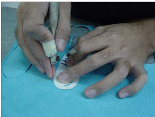
Corte del cuero con cuchillo de corte
