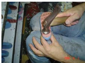
Postura de tachuelas de la plantilla a la horma por medio de martillo
