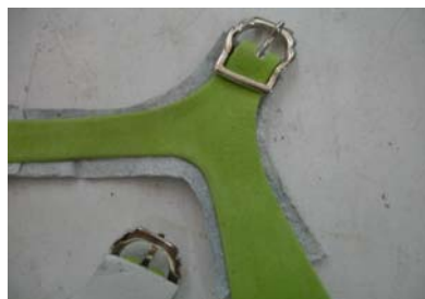
Postura de la hebilla en la talonera con el forro
