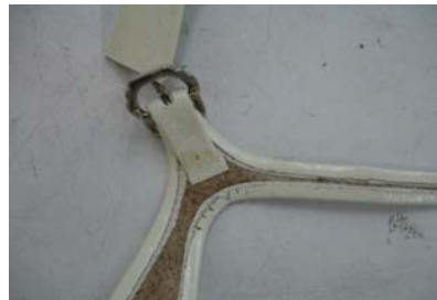
Postura del vástago de la hebilla sobre el perforado
