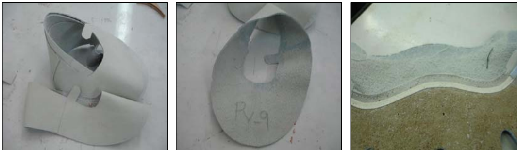
Foto 12. Armado de las piezas del forro completa a mano con solución de caucho
