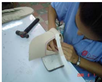
Armado de la talonera con la capellada.
