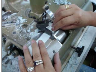
Foto 4. Desbaste de piezas en cuero y forro con máquina desbastadora
