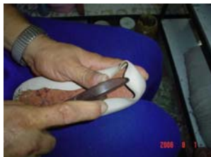
Montaje de corte de cuero por medio de pinzas a la horma.
