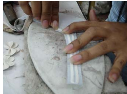
Foto 6. Postura del hiladillo sobre las correas para evitar desgarre de las piezas
