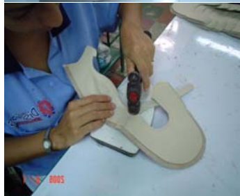
Asentamiento de las piezas armadas mediante el martillo.
