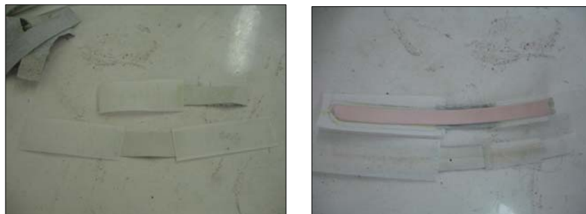
Foto 15. Postura de los velcros a la correa mediante pegante amarillo
