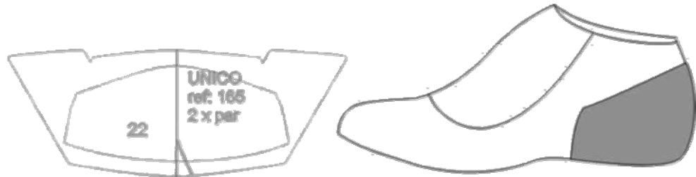
Figura 11. Posición de talonera en la horma y el corte en cuero
