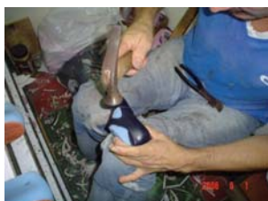
Postura de tachuelas de la plantilla a la horma por medio de martillo
