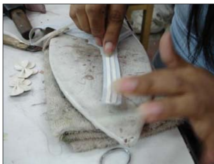
Foto 6. Postura del hiladillo sobre las correas para evitar desgarre de las piezas
