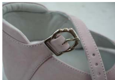
Hebilla en el talón costureada con la máquina de coser
