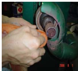
Eliminación de exceso de cuero con lijadora
