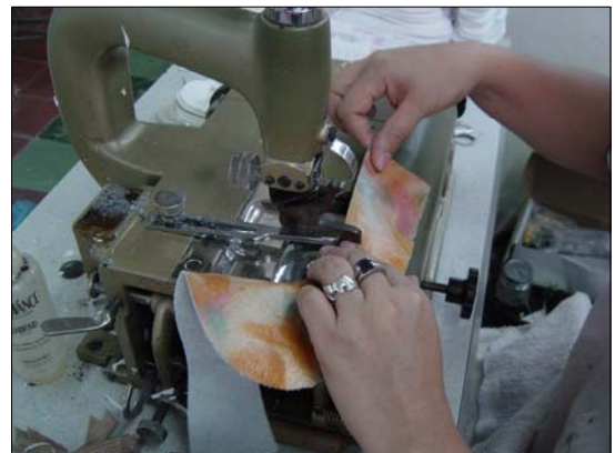
Desbaste de piezas con una desbastadora
