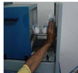
Reactivación de la suela y el corte montado mediante horno de calor
