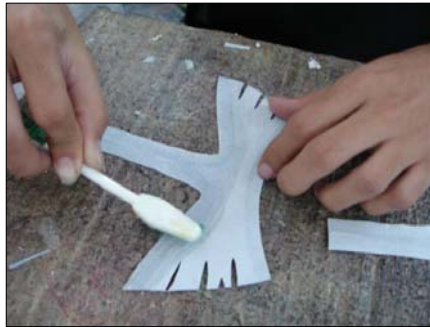
Foto 5. Engrudo de caucho a mano con cepillo sobre las piezas de cuero y forro
