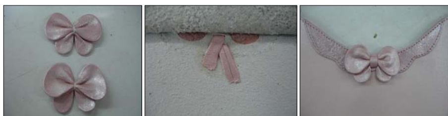
Amarre del moño con hilo y postura del mismo en la capellada mediante perforado
