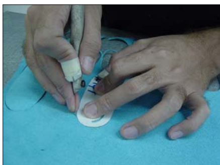
Foto 3. Corte piezas en cuero forro y abullonado con cuchilla de corte
