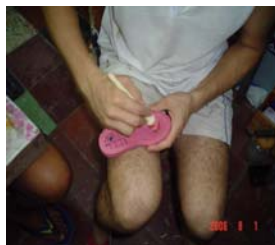
Engrudo de la suela mediante pincel
