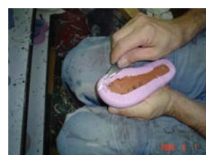
Postura de tachuelas con martillo para montar el corte a la horma.
