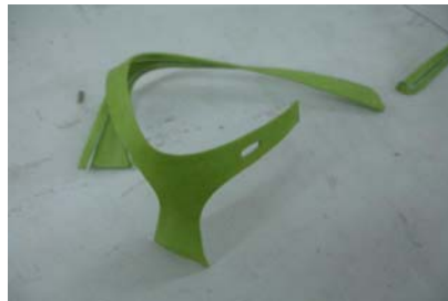
Perforado del hebillero con perforador
