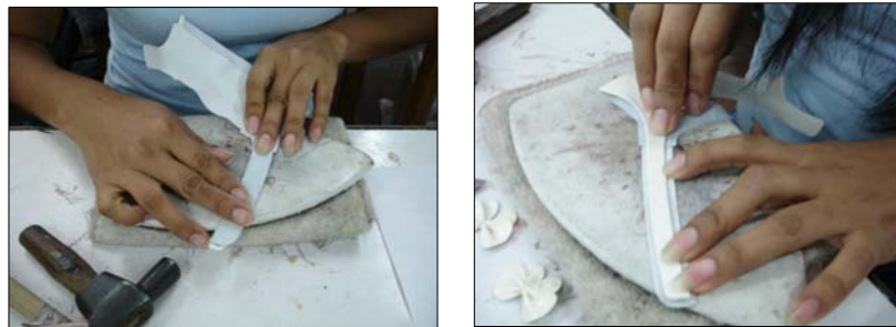
Foto 10. Posicionamiento del forro sobre correa
