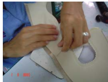
Pegue de piezas con solución de caucho amarillo.
