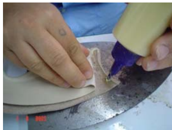
Pegue de piezas con solución de caucho amarillo.
