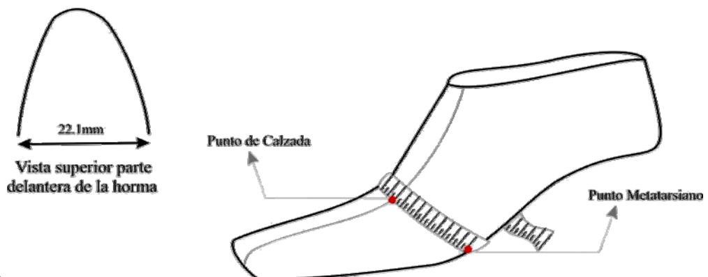
Figura 44. Medida de la calzada de la horma
