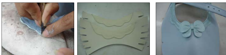
Dobles de la pieza con cuchillo de corte y costura con la máquina de coser
