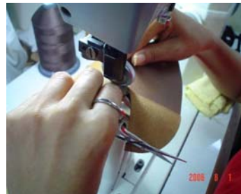
Armado de la talonera con la capellada.
