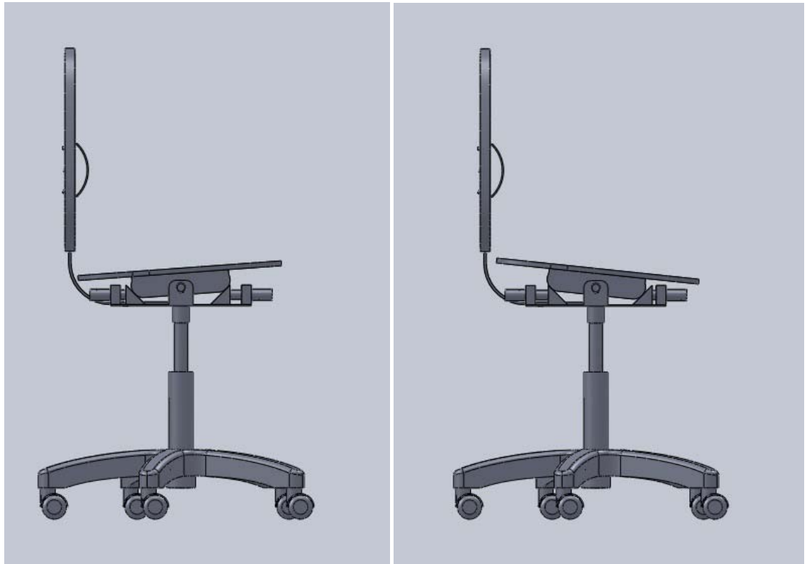
Figura 52. Variación de la inclinación del asiento vista lateral
