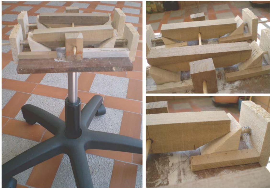
Figura 31. Mecanismo de balanza con resortes de compresión Escala 1:1
