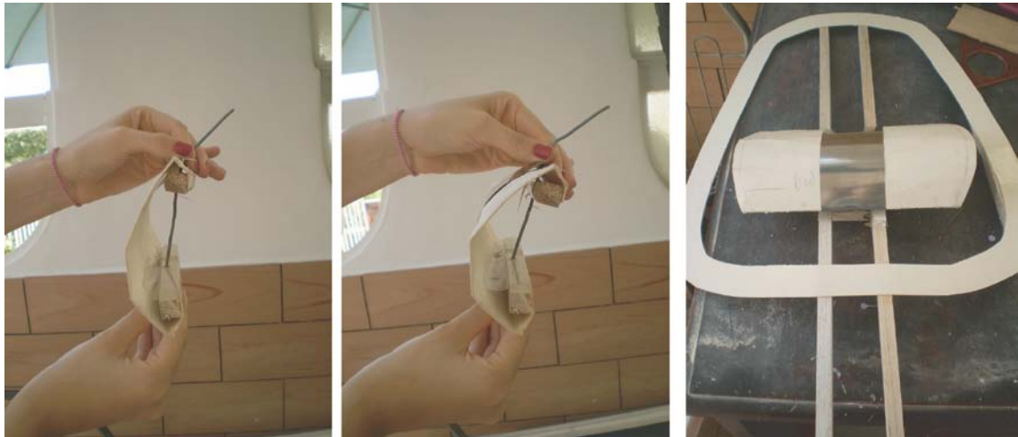
Figura 33. Mecanismo que mantiene el espesor del apoyo lumbar
