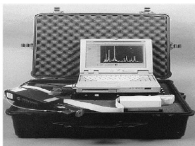
Figura 9. Instrumento portátil LIBS desarrollado para aplicaciones in-situ.
