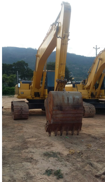
Figura 3. Excavadora de oruga Komatsu PC200LC.
