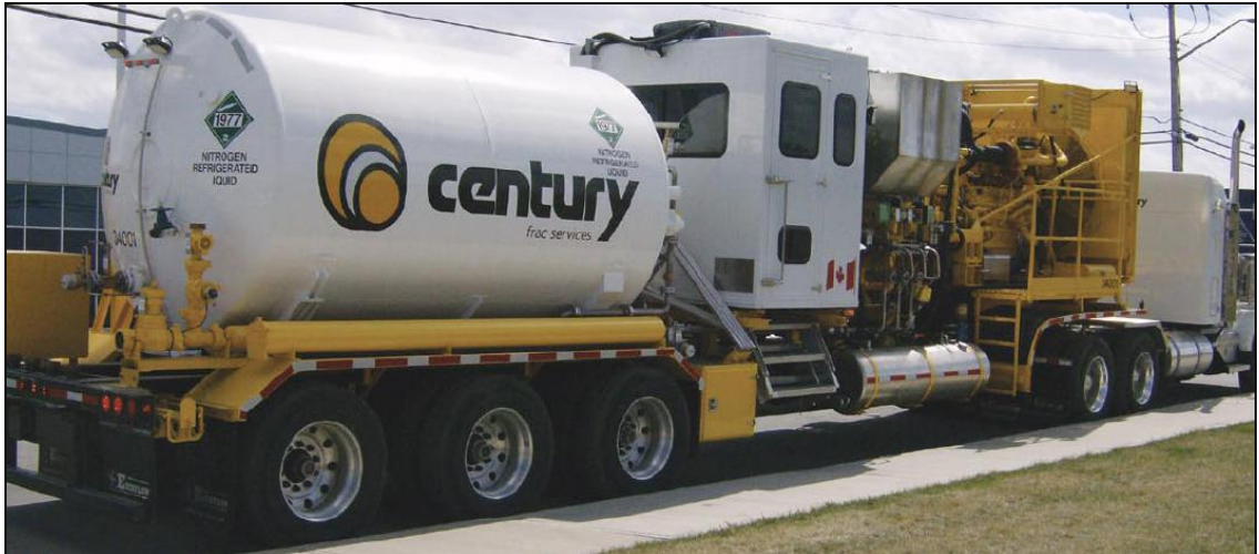
Figura 15. Equipo de Bombeo de Nitrógeno.
