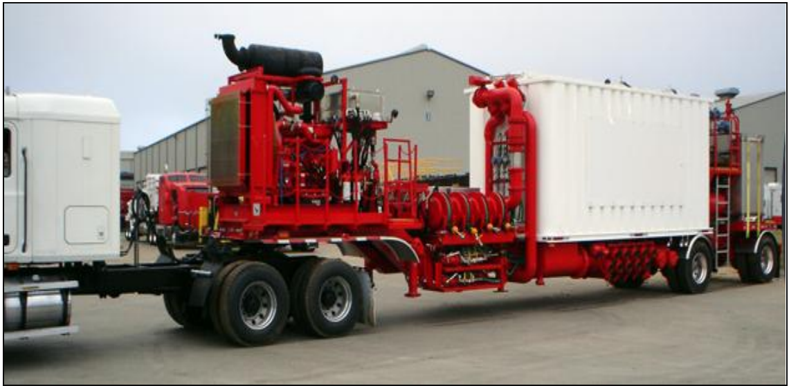
Figura 17. Sistema de Hidratación y Aditivos Químicos.
