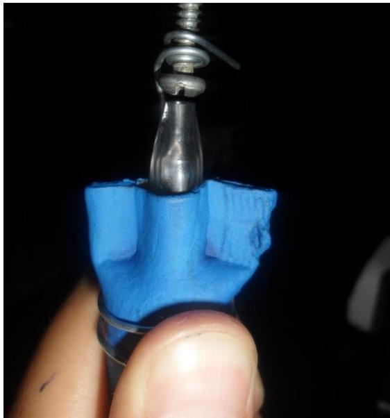
Figura 57. Funcionamiento y vista lateral del sistema de riego con aspersores caseros (Presión de 4m/H20).
