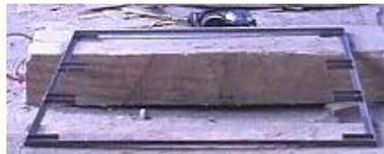
Figura 16 Plantilla Creada Para El Proceso de Ensamble de Estibas
