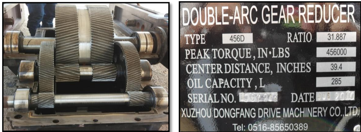
Figura 15. Caja de Engranajes SHEN LI 456D – 256 – 144 (izquierda) y Especificaciones Técnicas (derecha).
