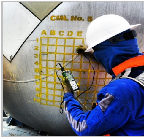
Fotografía 45: Medición de espesores Scan B en CML No 5 De la bala B-TK-001.
