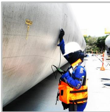
Fotografía 44: Medición de espesores Scan A En el cuerpo de la bala B-TK-001.
