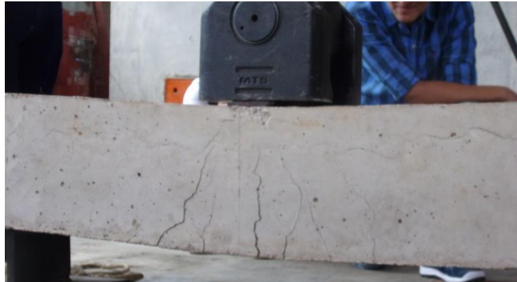
Figura 28. Falla de viga sub-reforzada.
