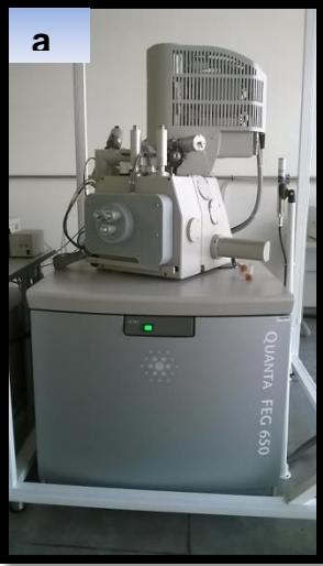
Figura 9. Equipos para el análisis SEM; a) Quanta 650 FEG ambiental, b) Quorum Q150R ES
