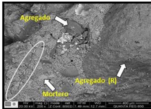
Figura 13. Micrografía realizada a los concretos con sustitución del AGN de 25%
