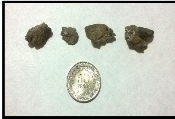
Figura 11. Muestras de concreto recubiertas con carbono para el análisis SEM
