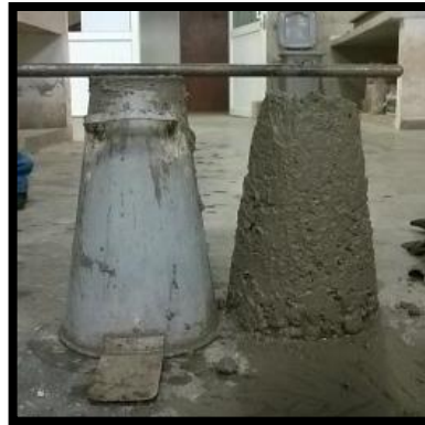
Figura 3. Ensayo de asentamiento (Slump)
