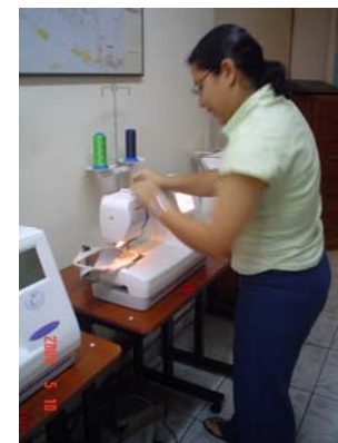
Foto 10 Montaje del hilo en la máquina bordadora
