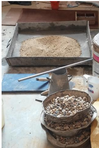
Figura 2. Elementos para la fabricación de probetas.
