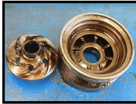
Figura 23 Impulsores y difusores de la bomba con desgaste en zona de down thrust.
