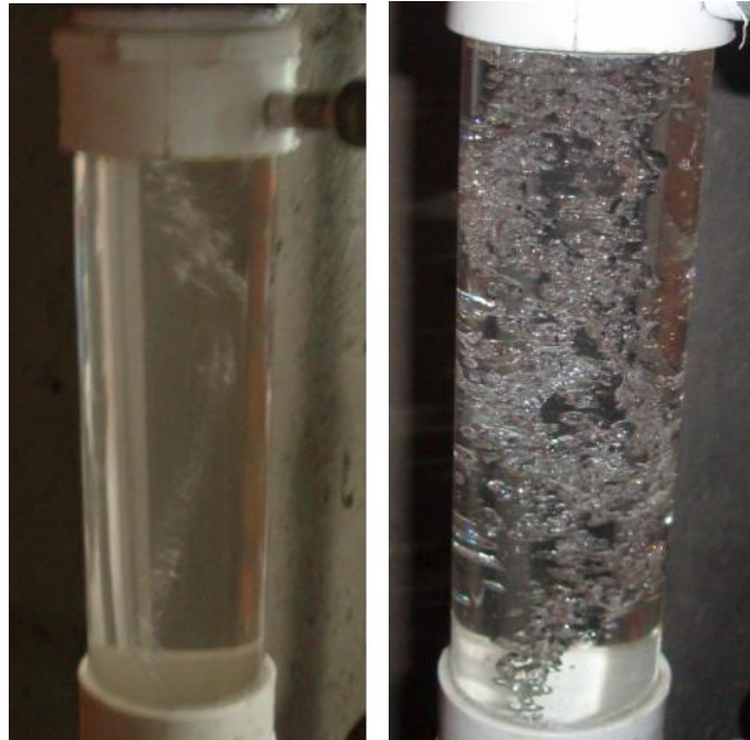
Figura 28. Resultado del sistema hidráulico 3 (cavitación incipiente)
