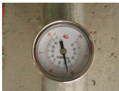
Figura 20. Termómetro de carátula bimetálico
