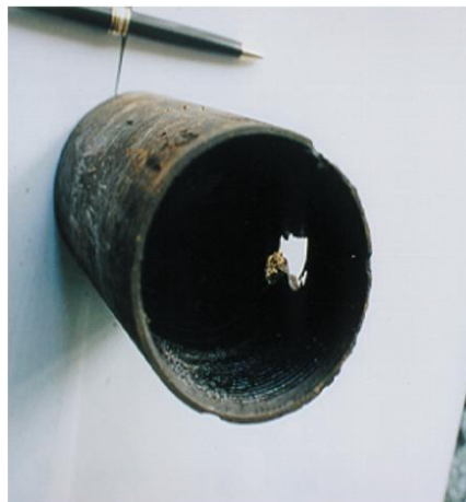
Figura 7. Falla del acople por corrosión
