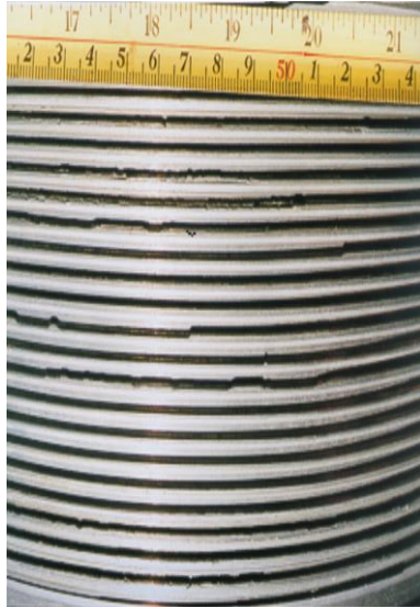
Figura 5. Falla en el roscado de la tubería Figura 6. Rompimiento de piñón en tubería en tubería
