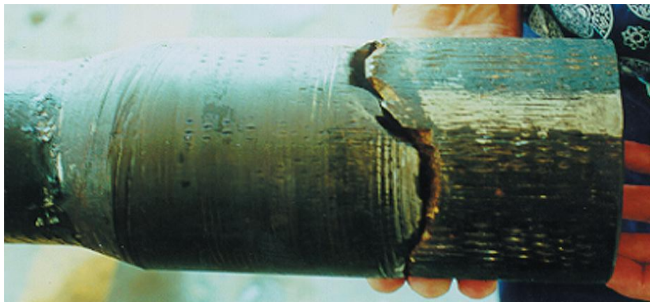
Figura 10. Fractura de caja en tubería de perforación
