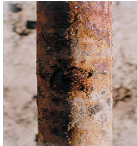
Figura 8. Corrosión en la tubería
