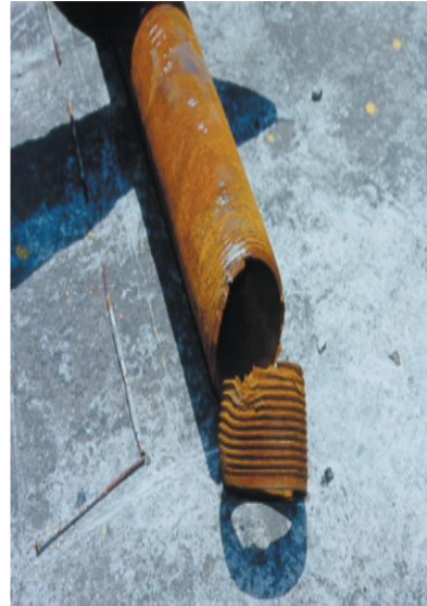
Figura 5. Falla en el roscado de la tubería Figura 6. Rompimiento de piñón en tubería en tubería
