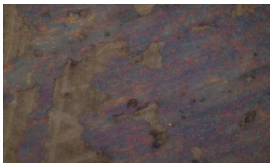
Figura 31 Micrografía acero ASTM A335-P9 a 250°C y 20 horas
