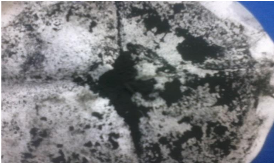
Figura 35 Precipitado obtenido de los frascos lavadores de gases.
