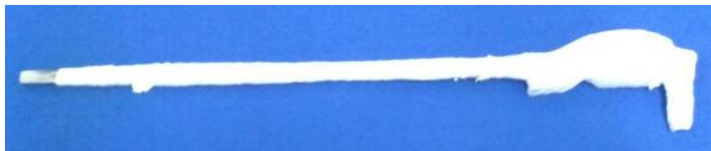
Figura 6 Probeta para los ensayos electroquímicos.
