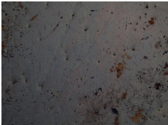
Figura 34 Micrografía acero ASTM A335-P9 a 250°C y 24 horas.
