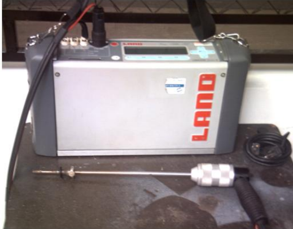
Figura 85. Fotografía del Analizador de gases de combustión
