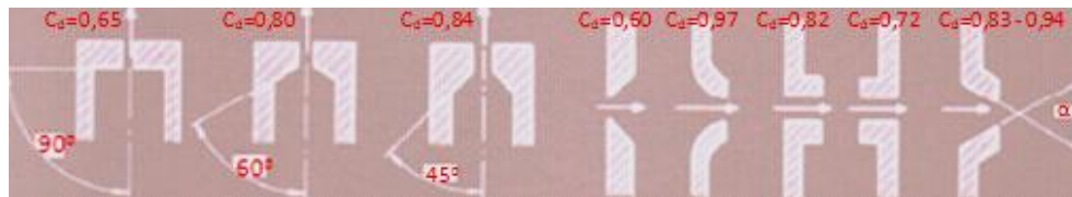
Figura 32. Valores del coeficiente de descarga para diversos tipos de geometrías internas diferentes
