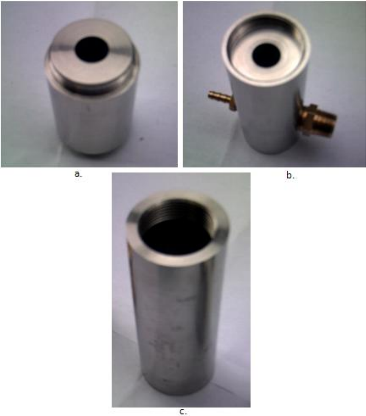
Figura 46. Tres secciones del mezclador (a) Sección media del mezclador donde finaliza el diámetro del cuello, (b) Sección inicial del mezclador donde se introduce el inyector, (c) Sección final del mezclador, donde se enrosca el estabilizador de llama
