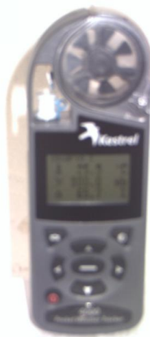
Figura 82. Anemómetro Kestrel usado para medir las condiciones ambientales
