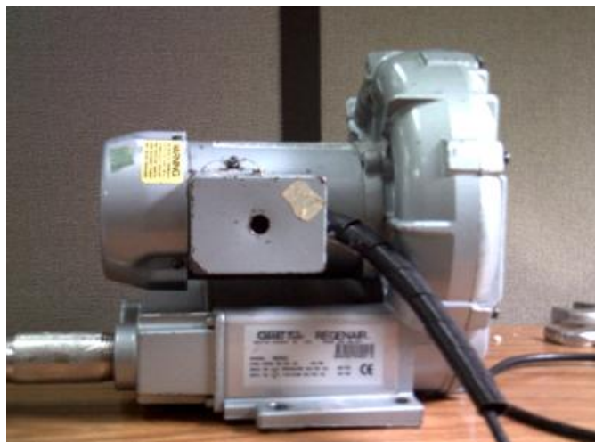
Figura 88. Blower regenerativo instalado
