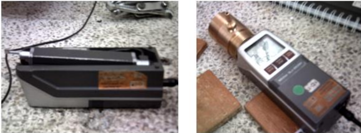
Figura 86. (a) Rugosímetro, (b) Prueba de rugosidad en un elemento del quemador
