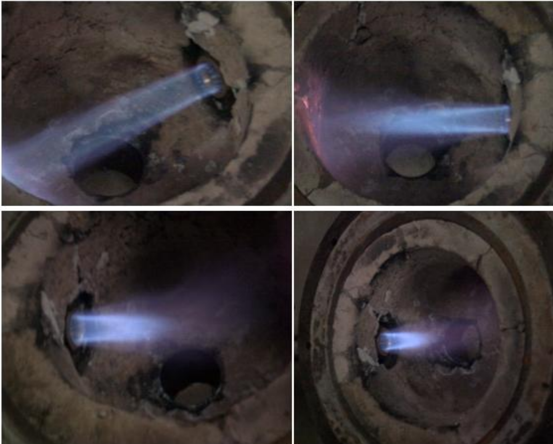
Figura 69. Fotos de la llama funcionando a diferentes caudales de aire y de gas natural
