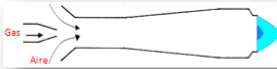
Figura 9. Quemador de premezcla a inducción, de gas inductor
