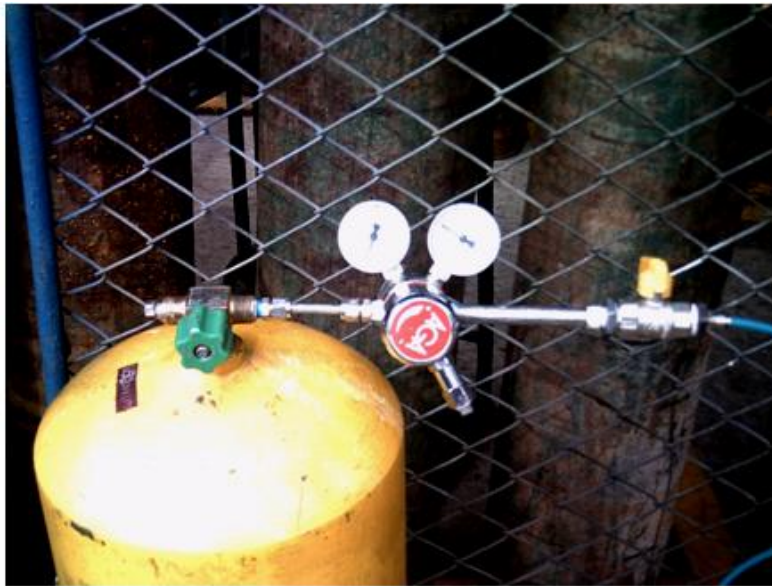
Figura 67. Regulador de dos etapas montado en un cilindro de GNV
