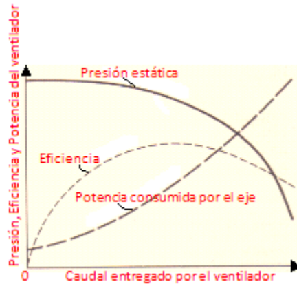
Figura 56. Curvas de funcionamiento de un ventilador
