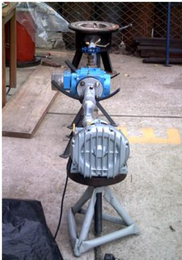
Figura 68. Montaje preliminar del quemador
