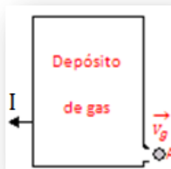
Figura 25. Diagrama de cuerpo libre de la descarga de un fluido de un tanque
