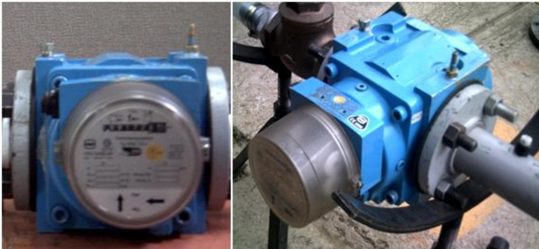
Figura80. Medidor rotativo para ser usado en las pruebas
