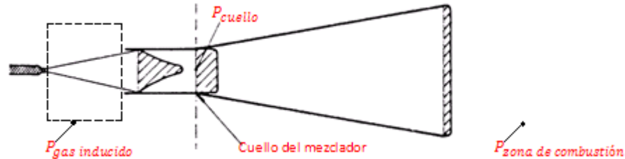
Figura 27. Efecto inductor del chorro libre inyectado sobre el mezclador
