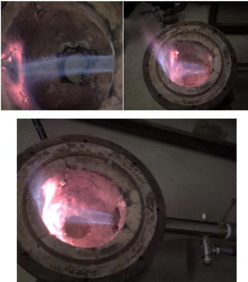
Figura 70. Fotos sobre el fenómeno de incandescencia dentro del refractario
