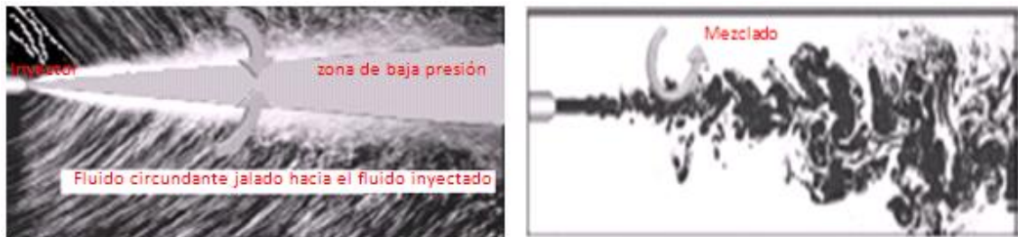
Figura 15. Fenómeno de arrastre y proceso de mezclado en la descarga de gases a atmosferas
