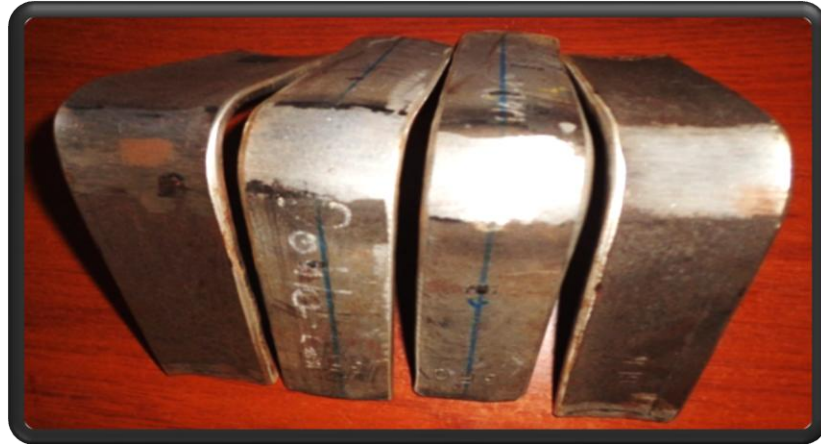
Figura 18. Doble de raíz y de cara de las probetas soldadas con el proceso GTAW-FCAW
