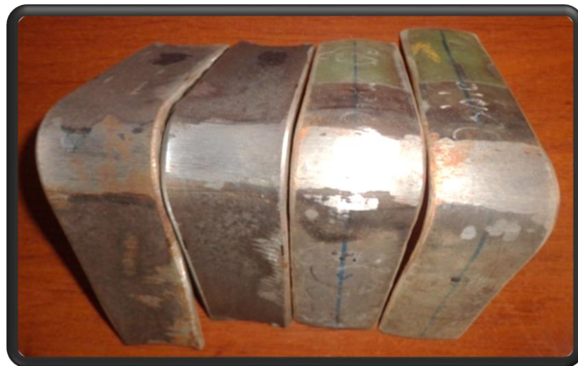
Figura 19. Doble de raíz y de cara de las probetas soldadas con el proceso SMAW-GTAW
