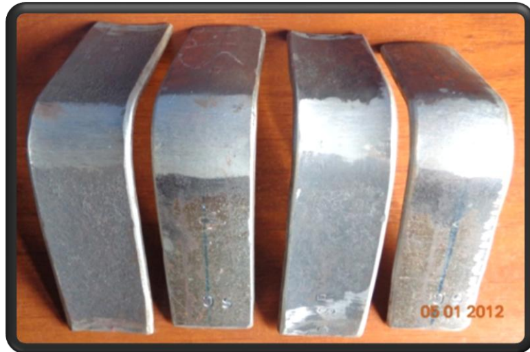
Figura 20. Doblez de raíz y de cara de las probetas soldadas con el proceso SMAW
