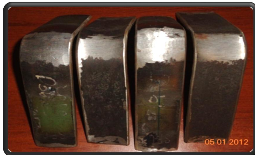
Figura 21. Doblez de raíz y de cara de las probetas soldadas con el proceso SMAW-FCAW
