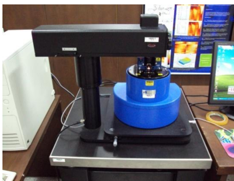
Figura 6. Equipo Veeco di CP-II del GOTS, UIS, utilizado para mediciones de AFM. Fuente: Autores.
