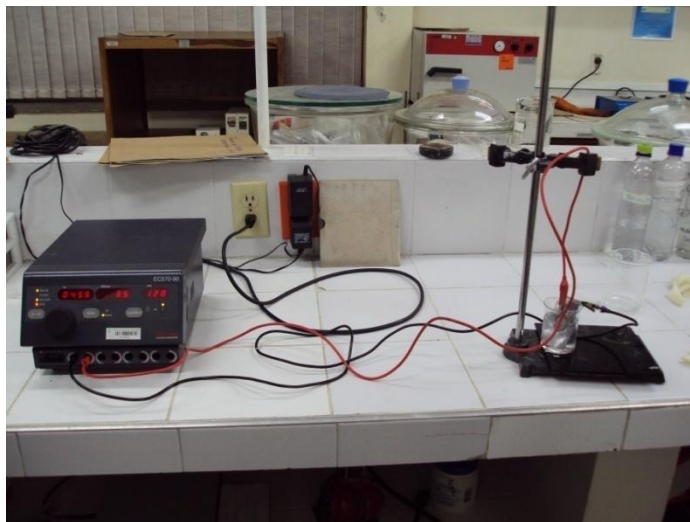
Figura 5. Montaje para anodizado galvanostático. Fuente: Autores.
