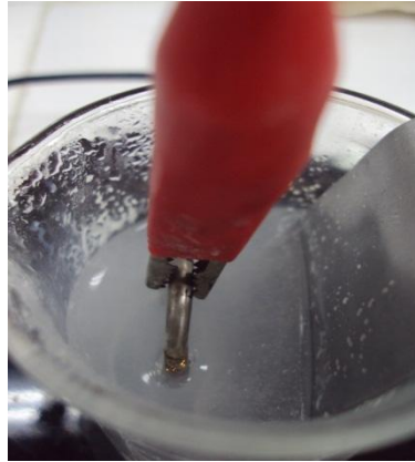
Figura 11. Generación de burbujas de oxígeno durante el proceso de anodizado galvanostático. Fuente: Autores.
