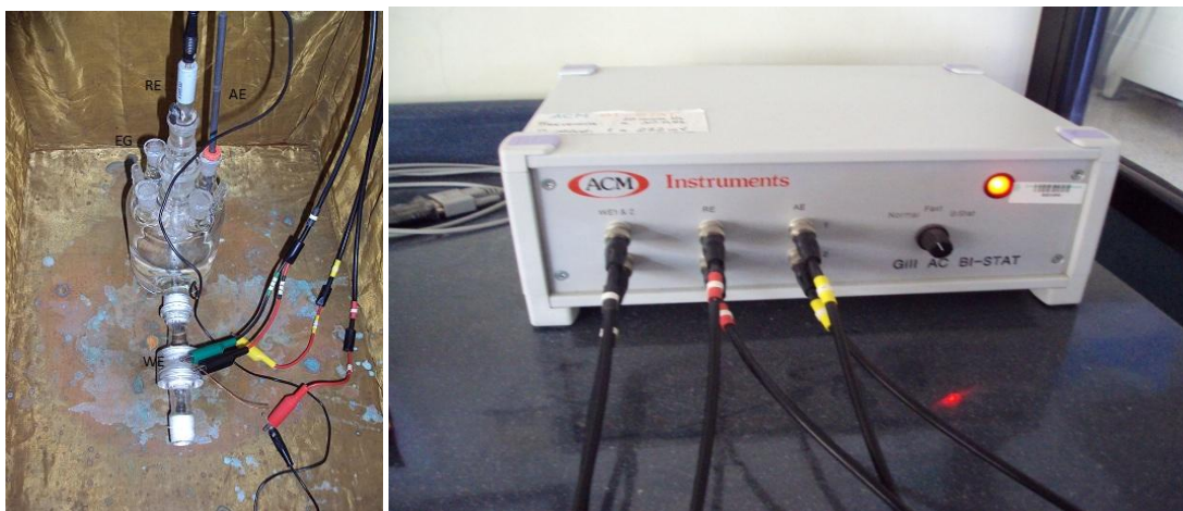
Figura 7. (a) Montaje para polarización catódica. (b) Bi-potenciostato ACM Gill AC BI-STAT. Fuente: Autores.
