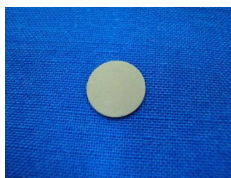
Figura 10. Probeta anodizada a 10 mA/cm 2 . Fuente: Autores.
