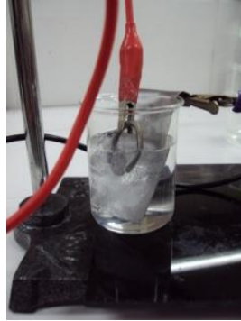
Figura 4. Montaje celda para anodizado. Fuente: Autores.
