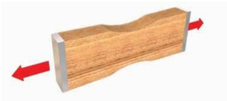
Figura 3. Tensión Paralela a las Fibras
