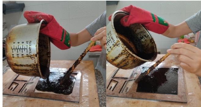
5. Esperar que endurezca el material interno y desmoldar:
