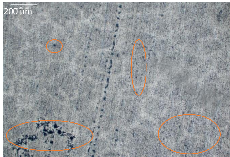
Figura 7. Micrografía óptica del aluminio con adición de 5% de polvos Ni-MH, Ataque con reactivo de Keller.
