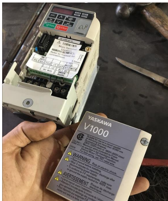
Figura 34. Variador de frecuencia
