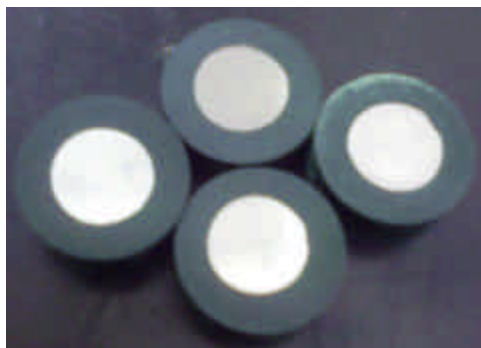
Figura 11. Probetas obtenidas con acabado superficial de 6 micras
