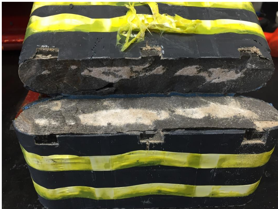
Figura 39. Evidencia del EF-2 después de prueba con concentración de 0.2 lb/ft 2 .
