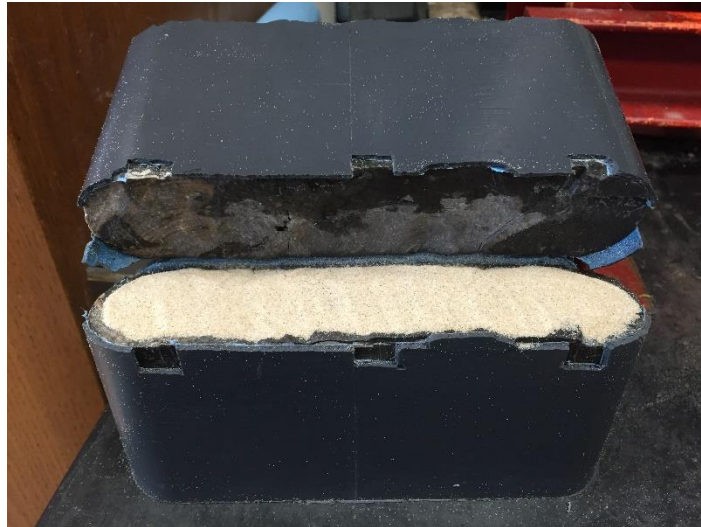
Figura 28. Distribución uniforme del agente sostén sobre la superficie de la fractura.
