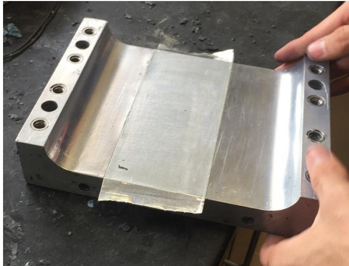
Figura 26. Recubrimiento del molde con cinta de aluminio.
