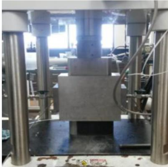
Figura 16. Equipo usado para medir la conductividad de la fractura.
