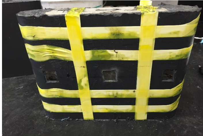
Figura 27. Muestra sellada con silicona, puertos para lectura de presión y cinta aislante de gas.
