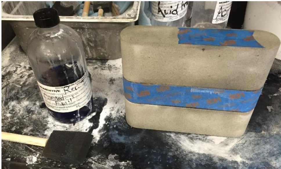
Figura 25. Muestra posterior a la aplicación del adhesivo.
