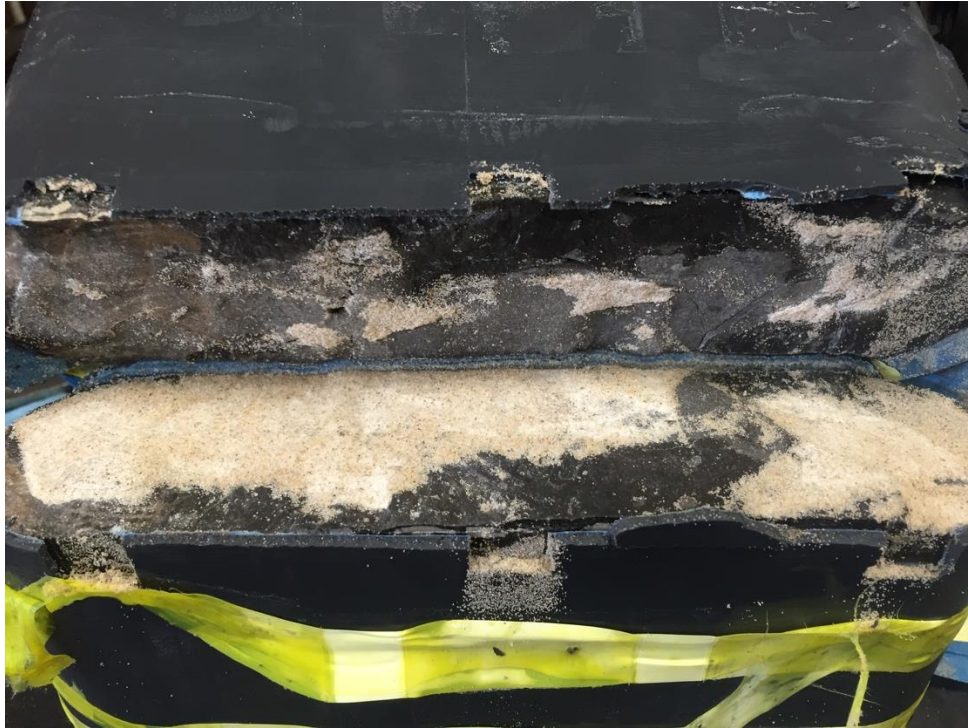
Figura 40. Evidencia del EF-2 después de prueba con concentración de 0.3 lb/ft 2 .
