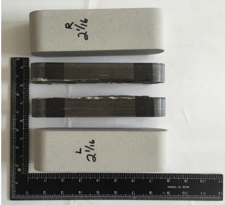
Figura 32. Muestra EF-2 con insertos de arena utilizados
