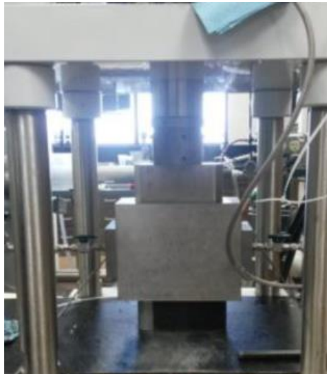
Figura 29. Montaje del equipo de laboratorio para realizar medición de la conductividad de las fracturas.
