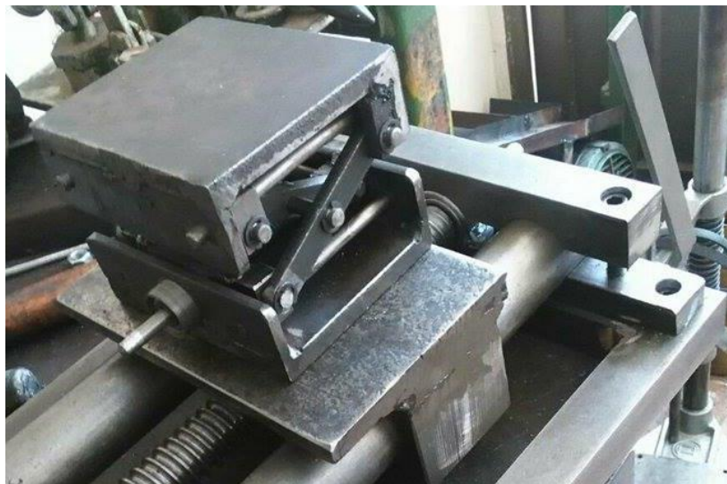
Figura 30. Mecanismo de elevación en construcción
