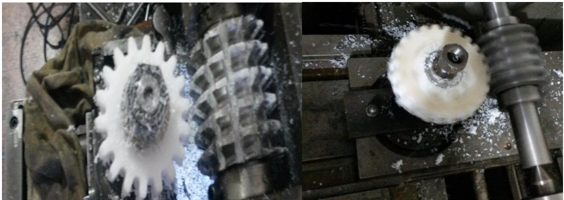
Figura 65. Pruebas de maquinado de piezas en los tres materiales
