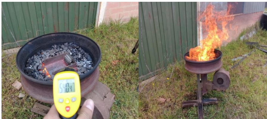
Figura 68. Calentamiento de la fresa madre y control de temperatura.
