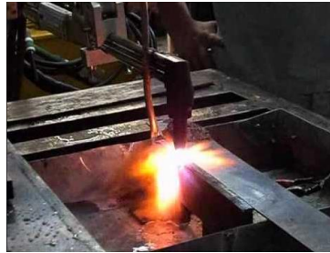
Figura 6. Endurecimiento superficial por flama
