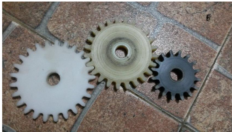
Figura 66. Engranajes producto de varias pruebas
