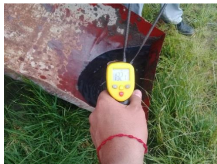
Figura 69. Registro de temperatura de enfriamiento
