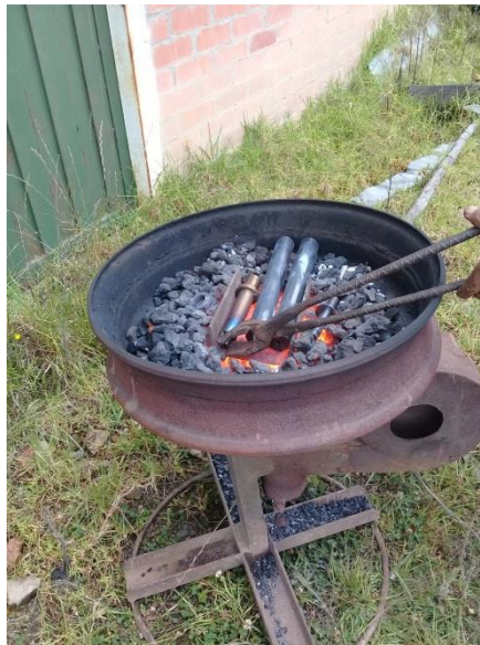
Figura 67. Fragua en proceso de endurecimiento de algunas piezas
