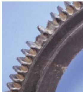
Figura 7. Fractura de dientes en engranajes
