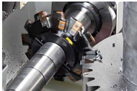
Figura 12. Maquinado de Fresa de forma
