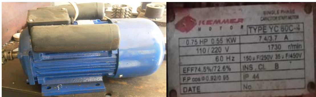
Figura 56. Motor monofásico del módulo/ placa del motor
