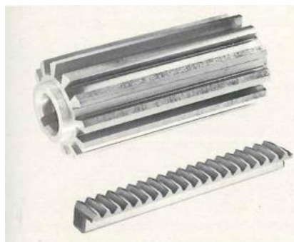
Figura 20. Cuerpo base y cuchilla de una Fresa Madre
