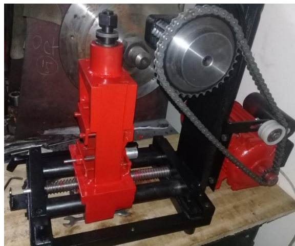
Figura 28. Componentes mecánicos del módulo de fresado
