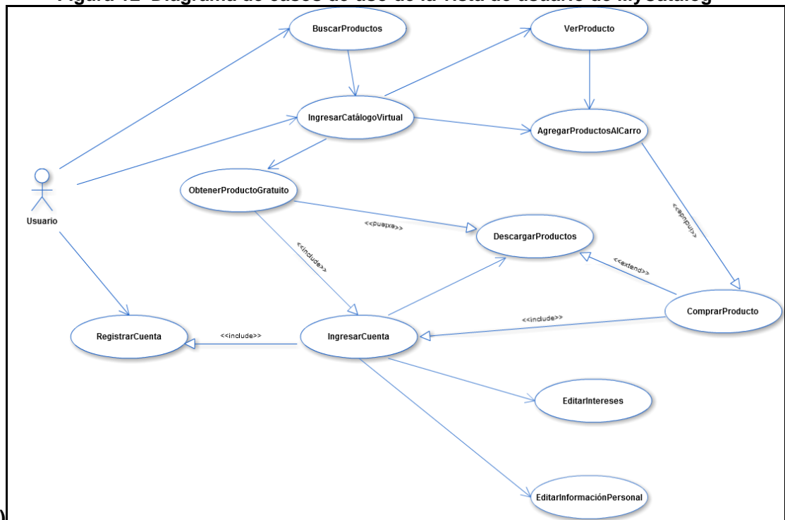
Figura 12 Diagrama de casos de uso de la vista de usuario de MyCatalog
